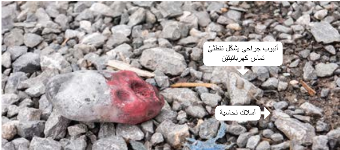
الصورة 6: مثال عن مفتاح سلك نحاسي. ملاحظة: يتم طلاء هذين السلكين النحاسيين بعازل من الورنيش الذي تتم إزالته عند النقطة حيث يُلفّ حول الأنبوب الجراحي من أجل تكوين نقطتي تماس كهربائيتين
