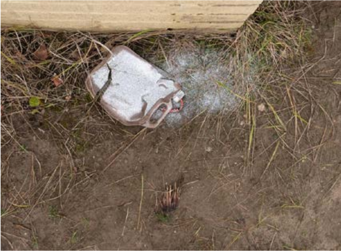
الصورة 49: شحنة رئيسية مهملة ممزقة مع مادة متفجرة يدوية الصنع ظاهرة للعيان بوضوح
