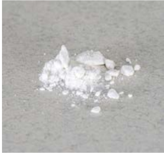
الصورة 51. بيروكسيد الباريوم (المصدر: قيادة الدفاع الكيميائي والبيولوجي والإشعاعي والنووي في الجيش الألماني ©)
