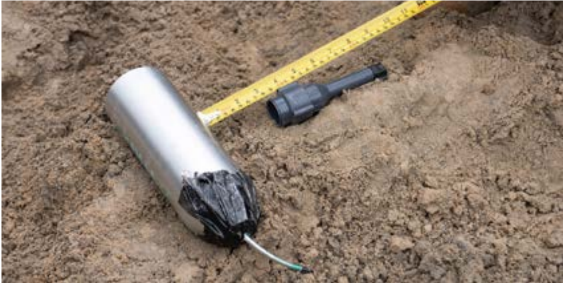
الصورة 8: شحنة جوفاء مع أنبوب من المغنيسيوم مخروطي الشكل، مليء بمواد شديدة الانفجار بوزن 50 غ، مزروعة على بُعد 75 ملم من شحنة رئيسية متروكة لعبوة ناسفة مبتكرة
