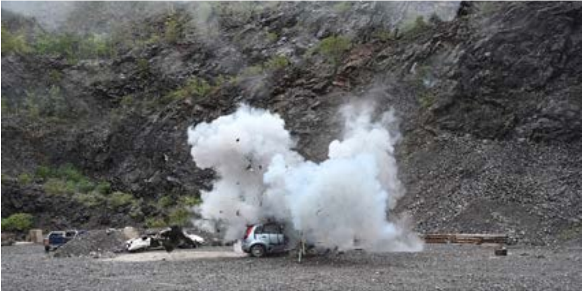
الصورة 13: وميض مقموع بالكامل وعدم اشتعال حريق في المركبة
