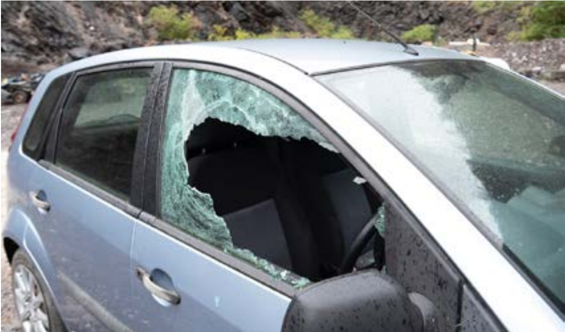
الصورة 7: تحطيم المفجر النافذة بنجاح من خلال العمل عن بُعد جزئيًا
