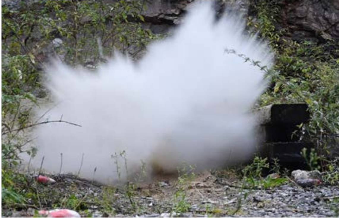
الصورة 18: مع تزايد حجم عصف الانفجار، تقمع الواجهة المائية المتنامية الحرارة والوميض الناجمين عن التفجير
