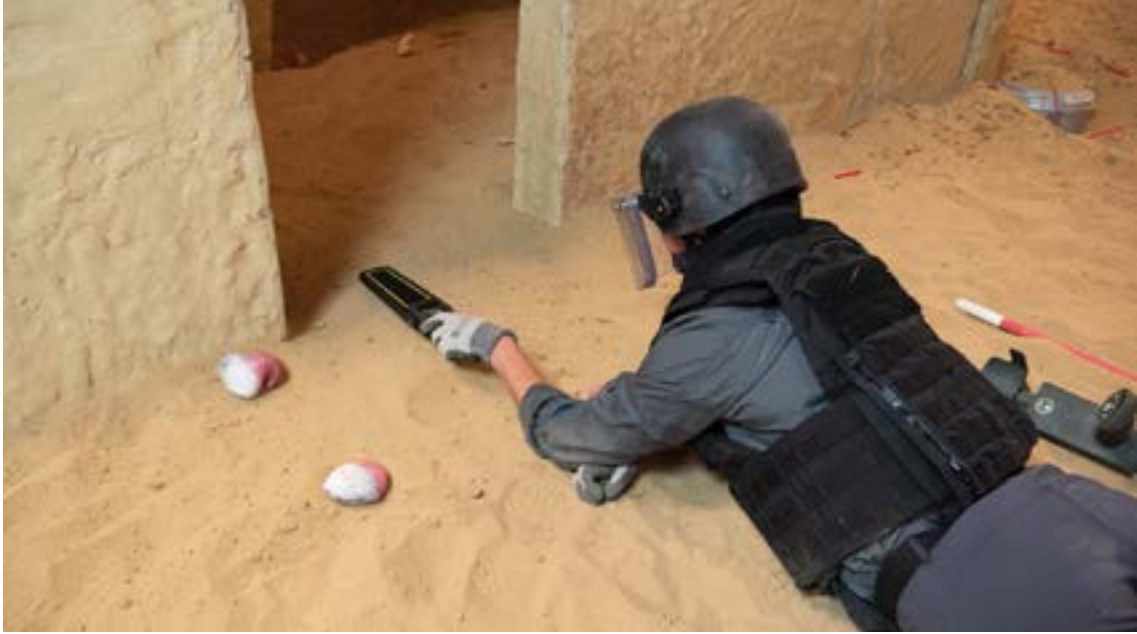
الصورة 17: يتم استخدام جهاز الكشف عن المعادن على شكل العصا، لتحديد المكونات تحت السطح بدقة أكبر
