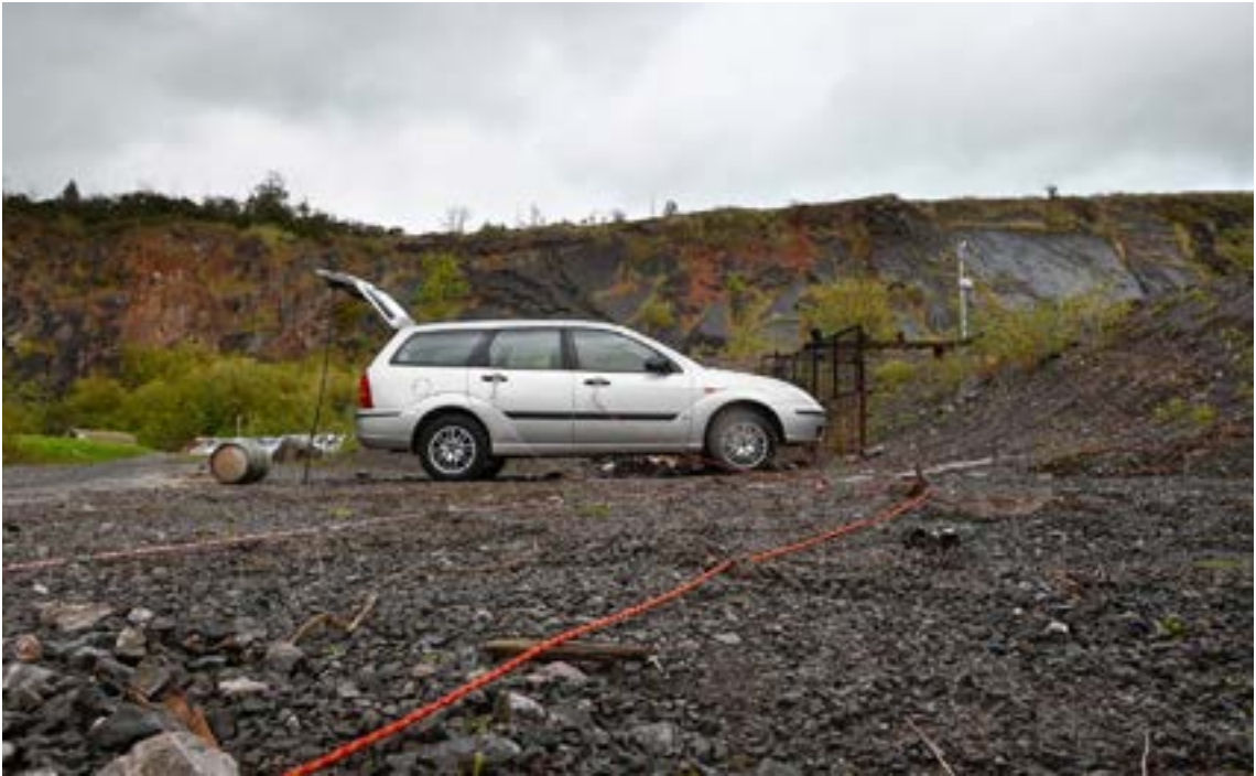
الصورة 15: تم ربط الحبال بشكل مستقل بكل باب باستخدام مفاتيح "القبضة"
