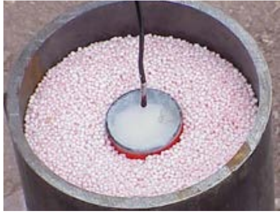
الصورة 142. نترات الأمونيوم وزيت الوقود مع دافع سداسي ميثيلين ثلاثي بيروكسيد ديامين (المصدر: شركة بريمنغتون للاستشارات (ش.م.))
