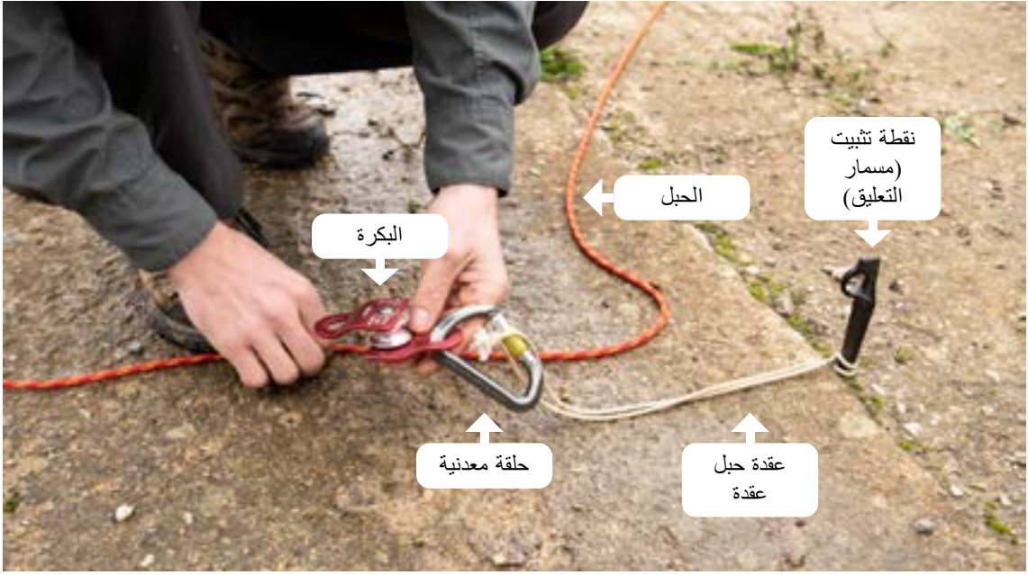
الصورة 8: مثال على المعدات النموذجية لتغيير الاتجاه وأدوات التثبيت مع مسمار التعليق، وعقدة (pursik) وحلقة معدنية وبكرة
