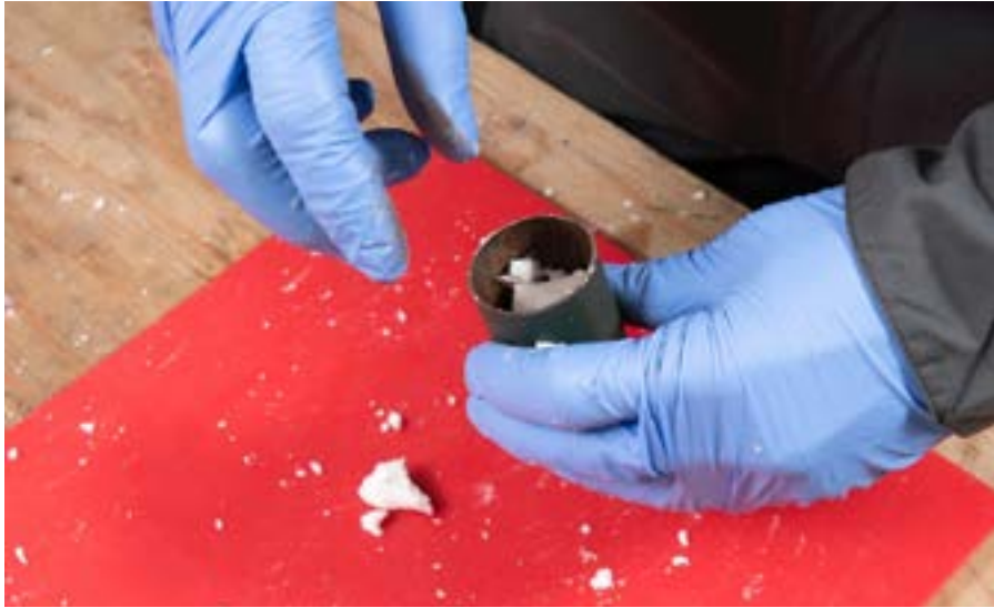
الصورة 12: شحنة جوفاء مقصودة يدوية الصنع يتم تعبئتها بالمتفجرات. يمكن ملاحظة القطع الصغيرة التي تتم إضافتها والتي سيتم رصّها بعد ذلك لتفادي الفراغات الهوائية
