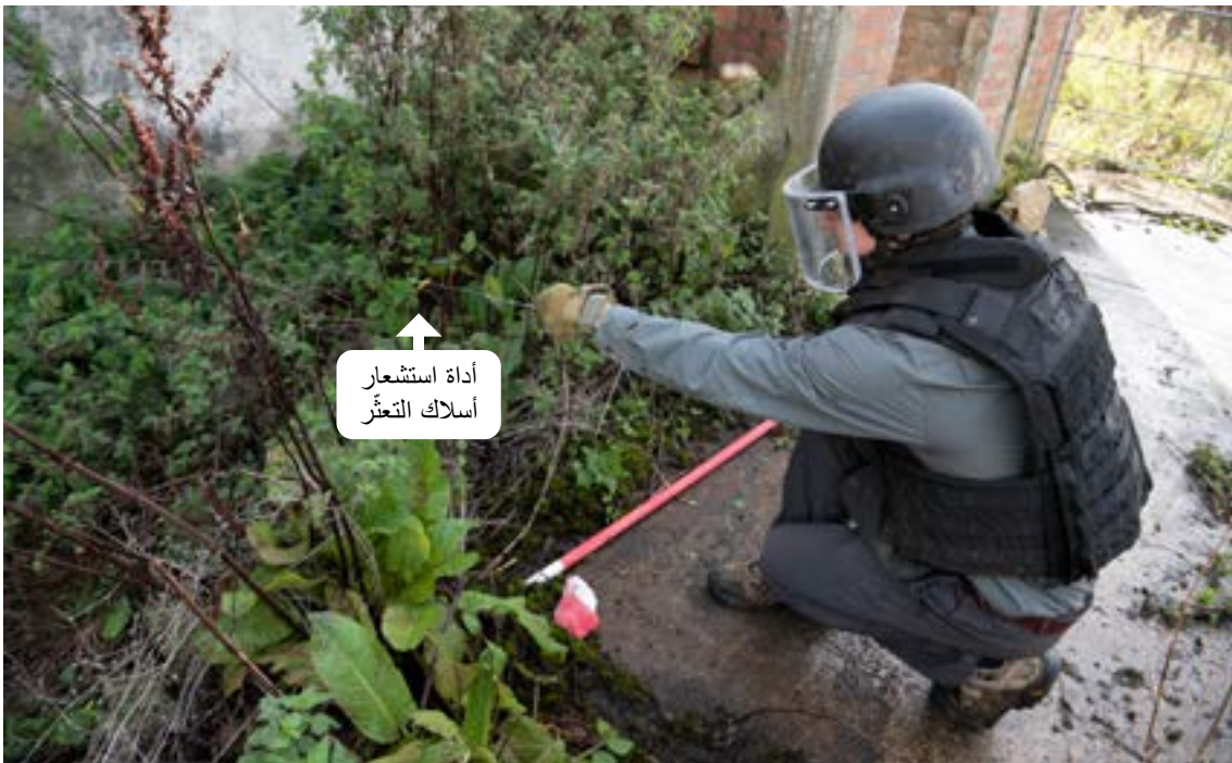
الصورة 2: استخدام أداة استشعار أسلاك التعنّز لمساعدة البحث البصري في الطبقة العلوية من الغطاء النباتي
