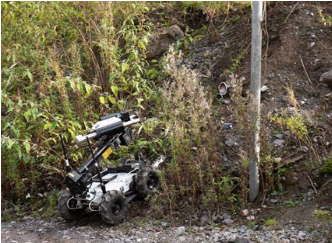
الصورة 2: مركبة تُشغّل عن بُعد تقوم باستطلاع الذخائر و المواد المتفجرة لمجموعة مقذوفات متفجرة موضوعة على جانب الطريق
