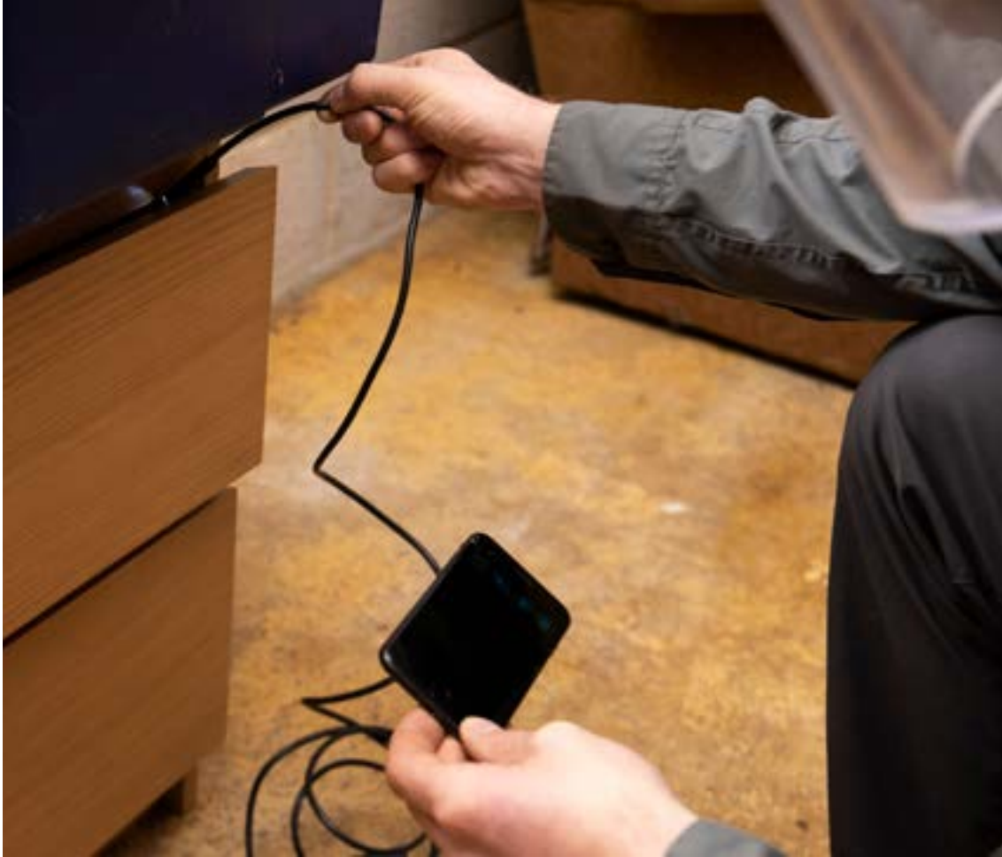
الصورة 16: أداة بصرية تُستخدم مع هاتف ذكي للبحث داخل الأثاث
