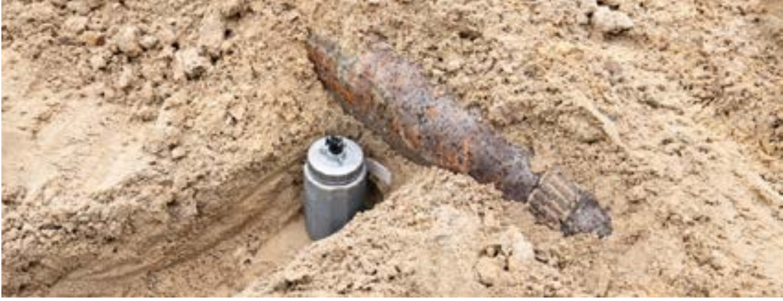
الصورة 4: شحنة معبأة تجارية موضوعة في قناة محفورة لاستهداف مصدر الطاقة في مفتاح منع الرفع
