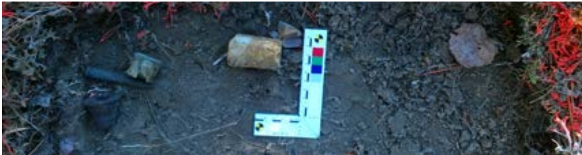
الصورة 2. مثال على مركب متفجر متجانس: ثالث نترتيت التولوين (TNT) (مُسَعَمَل هنا كحشوة للقذائف المدفعية) (المصدر: مركز جنيف الدولي لأنشطة إزالة الألغام للأغراض الإنسانية © GICHD)
