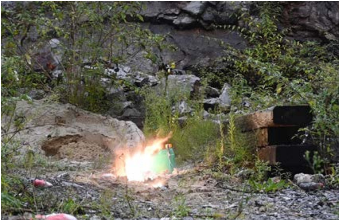
الصورة 17: يتمّ تشغيل المعطّل من نقطة المراقبة الآمنة. يمكن ملاحظة مقدار الحرارة والوميض مباشرةً عند التفجير
