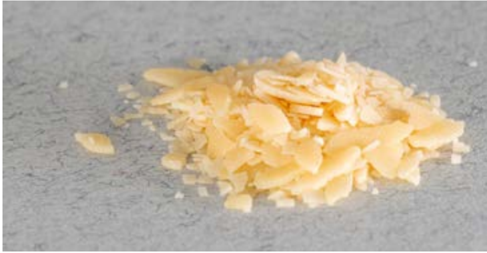
الصورة 7. مادة تي أن تي الصناعية (المصدر: قيادة الدفاع الكيميائي والبيولوجي والإشعاعي والنووي في الجيش الألماني ©)
