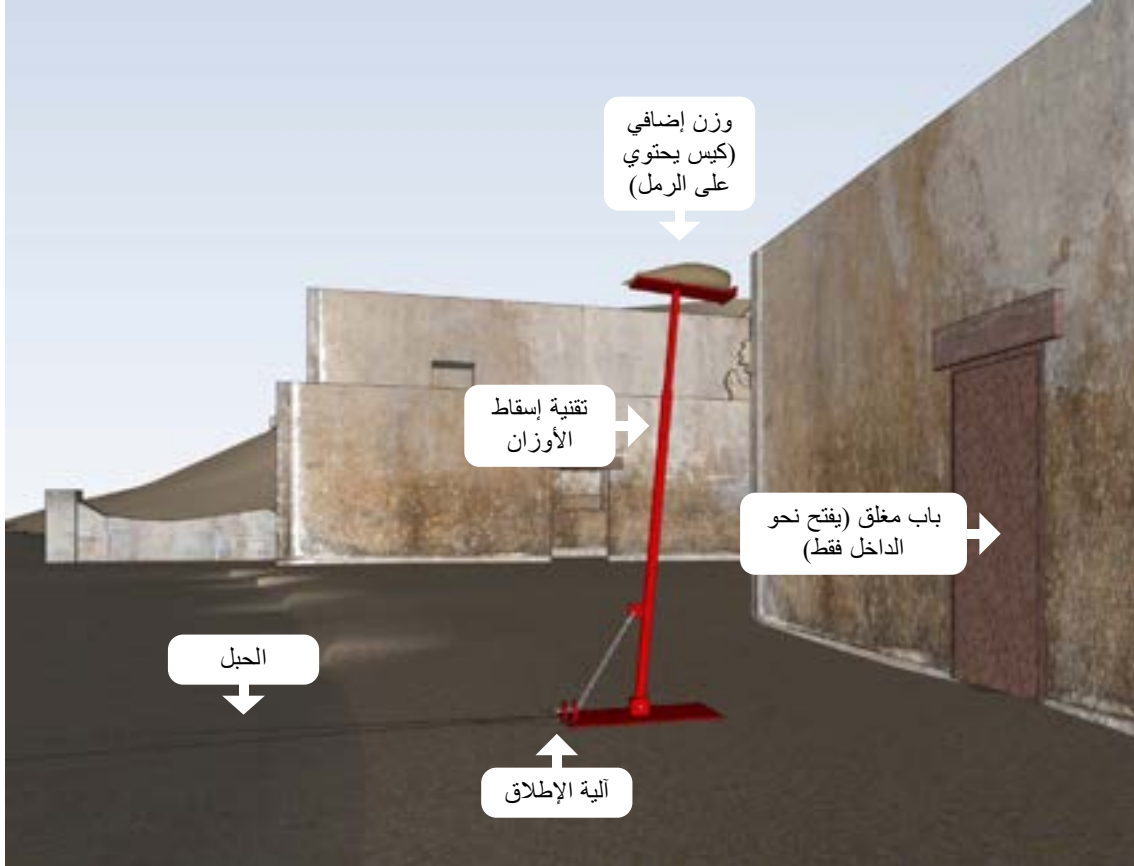
الصورة 14: صورة لتقنية إسقاط الأوزان في الموقع. الانتباه إلى أن نظام القاعدة يسمح بإطلاق الآلية وإسقاطها عبر الحبل من مسافة آمنة
