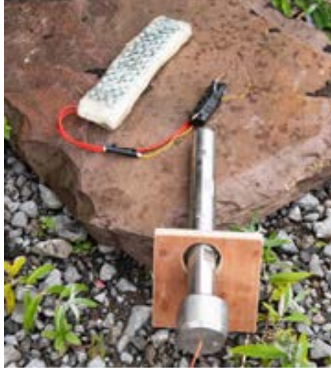
الصورة 5: برميل تعطيل يستهدف مصدر الطاقة على حزام ناسف مهجور. تم استخدام منصة حمل المعطل مصنعة محليًا للمساعدة في الوضع الصحيح
