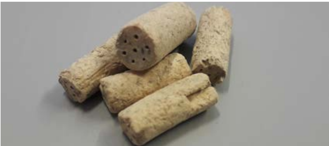
الصورة 20: مثال آخر عن مادة دفع مصنوعة من النيتروسييلولوز. يزيد حفر الثقوب من مساحة الحبيبات، وبالتالي، من الاحتراق. (المصدر: قيادة الدفاع الكيميائي والبيولوجي والإشعاعي والنووي في الجيش الألماني ©)
