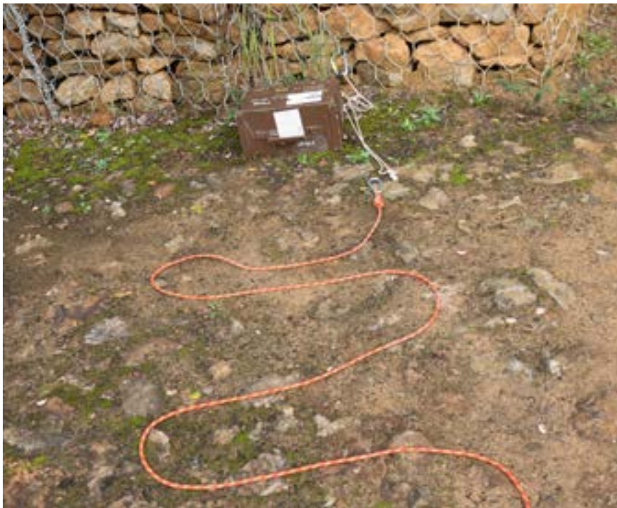
الصورة 1: تمّ تجهيز الخطّاف والحبل ويتمّ الانتظار لربط الحبل الرئيسي على أداة شحذ. لاحظ إرخاء الحبل الرئيسي، وكيف أنّ الحبل مُثبت بنقطة صلبة لفتح الحاوية
