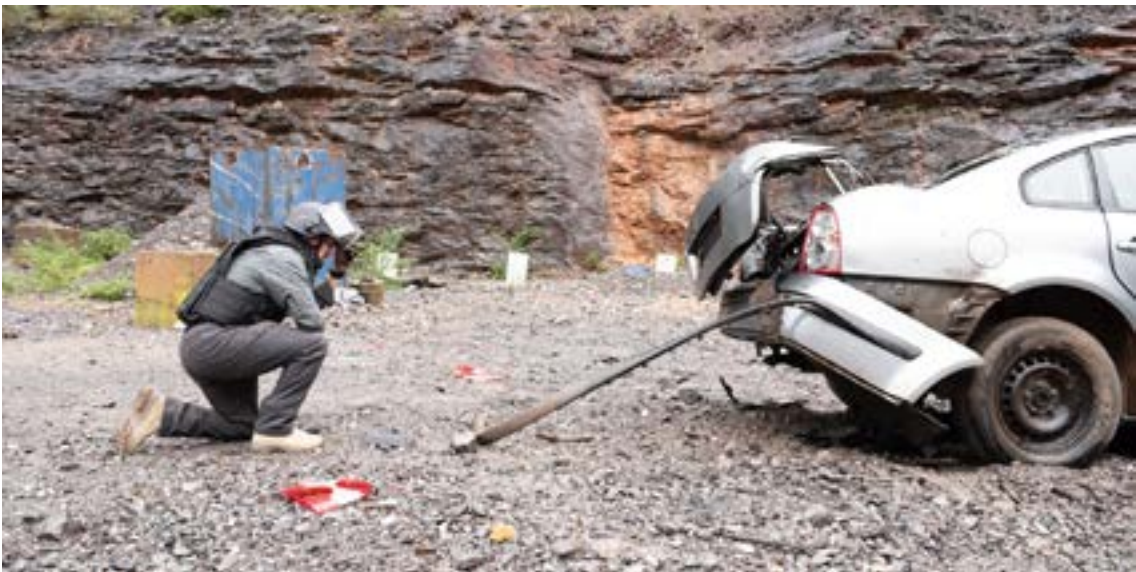
الصورة 37: مسؤول عن التخلص من العبوات الناسفة المبتكرة يعاين النتائج بعد تفعيل مستخرج العبوات الناسفة المبتكرة الموضوعة في المركبات
