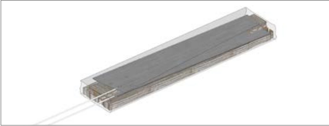
الصورة 45: صورة لشفرتين معدنيتين لمنشار مستخدمتين كلامسات كهربائية
