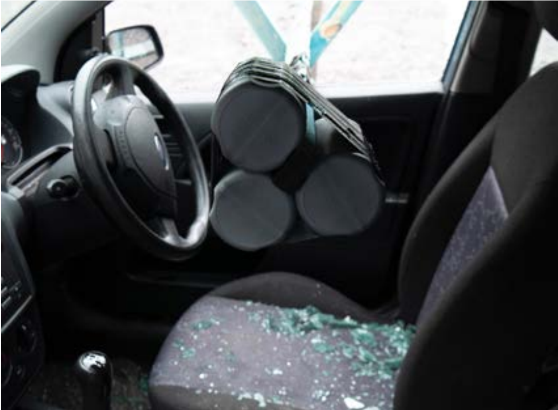
الصورة 9: معطل للعبوات الناسفة المبتكرة الموضوعة في المركبات معلق في وسط مقصورة الركاب
