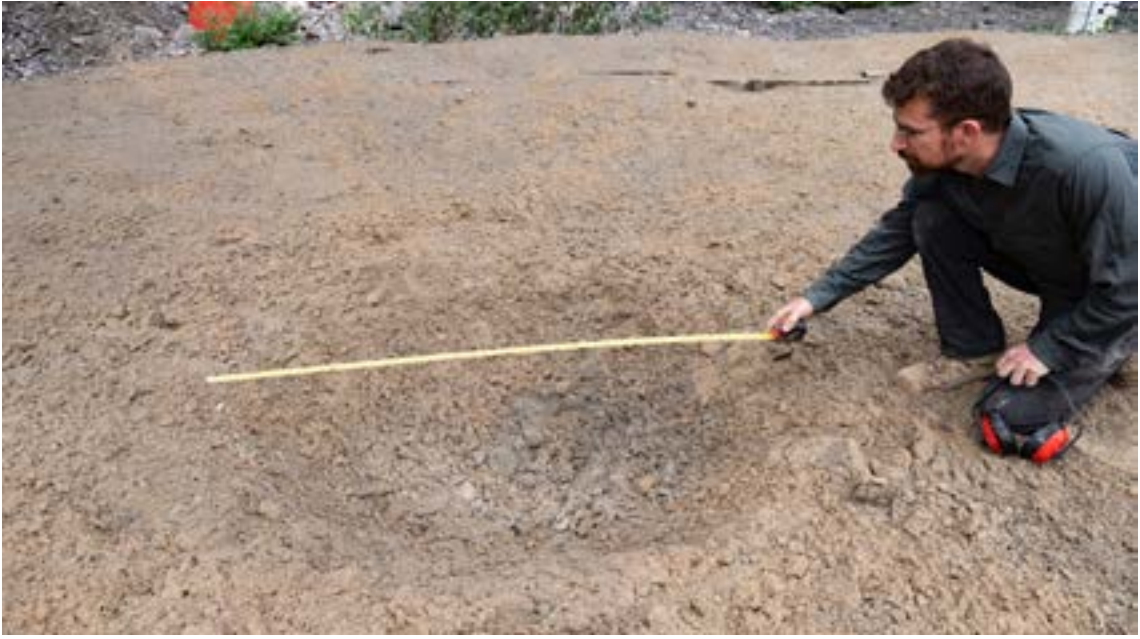
الصورة 5: اخترقت الشحنة الجوفاء بنجاح الرمل وحققت تفجيراً شديداً للشحنة الرئيسية المطمورة
