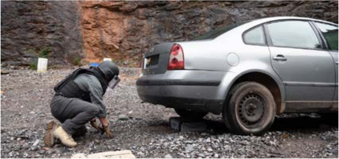
الصورة 30: مستخرج العبوات الناسفة المبتكرة الموضوعة في المركبات في وضعيته النهائية
