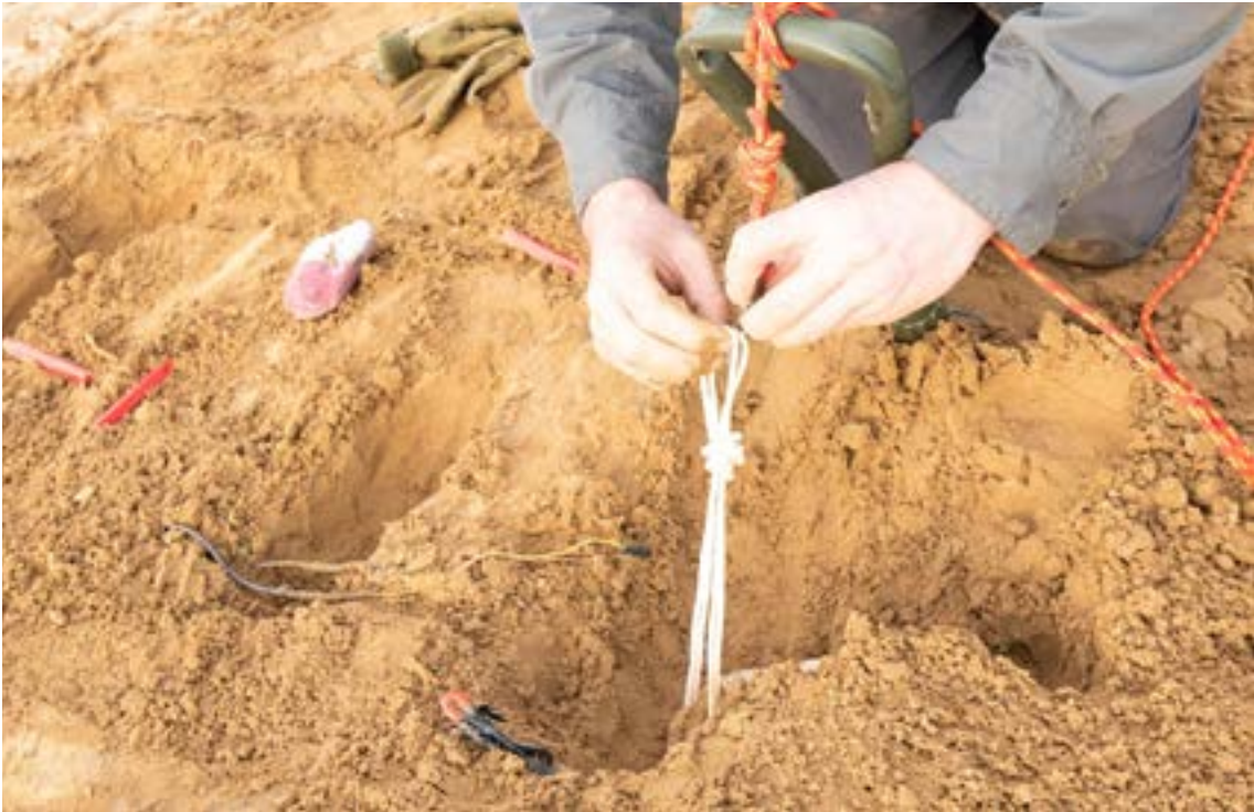
الصورة 8: يقوم المشغل المعني بالتخلص من العبوات الناسفة المبتكرة بإرفاق الحبل بأداة الشحذ. ملاحظة: تم تثبيت الحبل بمقبض المجرفة، التي تميل إلى الأمام قليلاً
