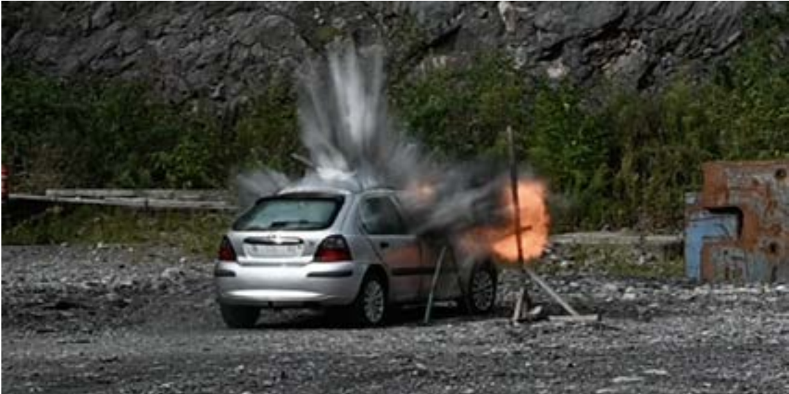
الصورة 21: تشغيل معطل العبوات الناسفة المبتكرة الموضوعة في المركبات. يمكن ملاحظة الوميض الناجم عن فتيل التفجير، لكنّ الماء قمع إلى حدّ كبير حجم الانفجار في المعطل، مطلوب نسخة عالية الدقة من الفيديو
