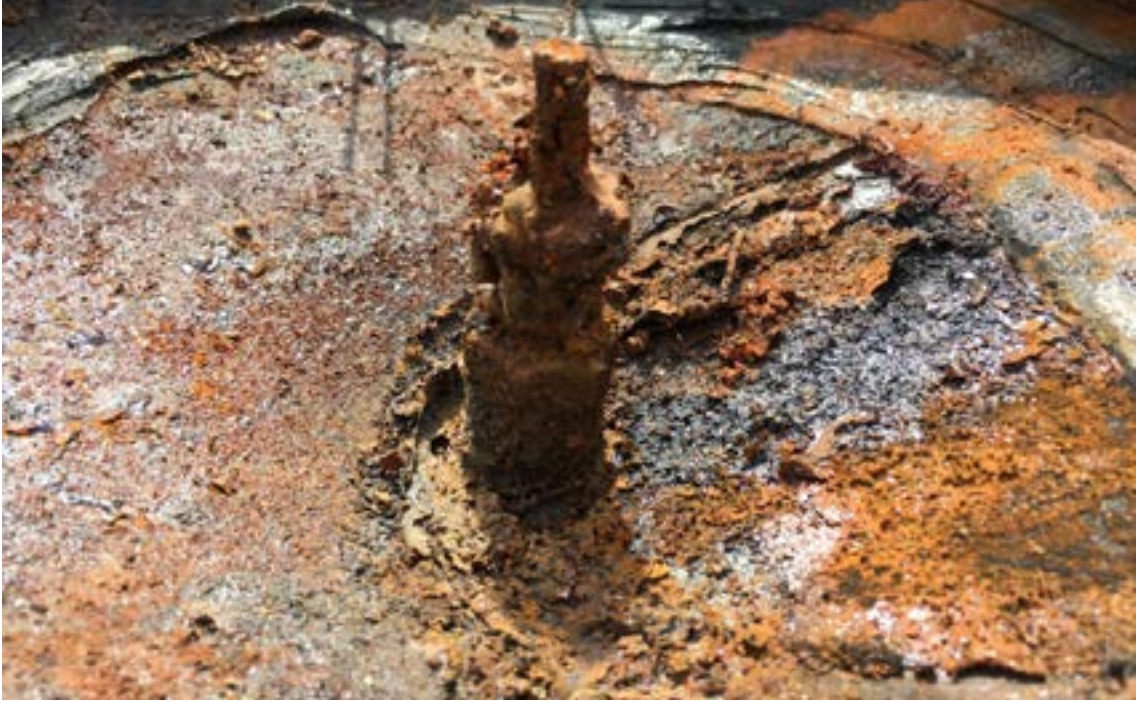
الصورة 116. قاذف مجهز خاص بـ VS-500 متآكل بفعل التقادم (المؤسسة السويسرية لمكافحة الألغام).
