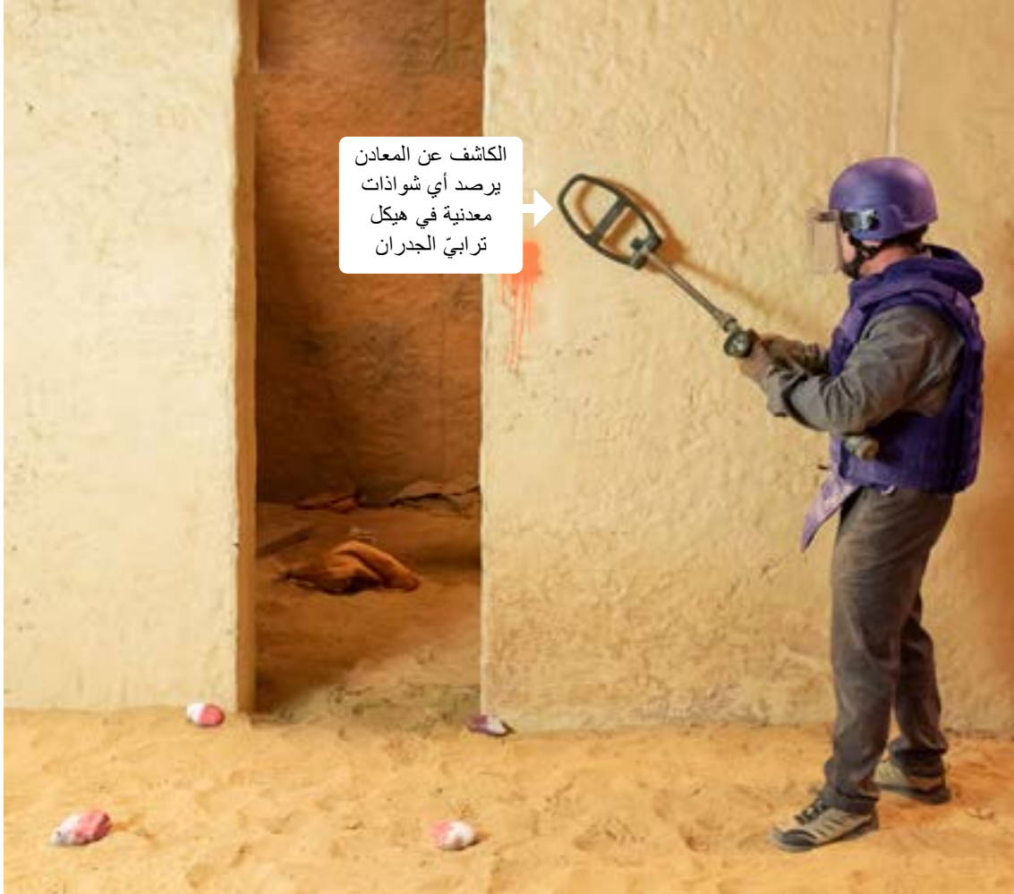
الصورة 7: تحتوي بعض المباني على القليل من المعادن في هيكلها، إلا أن الكاشفات عن المعادن قد تُعتبر مفيدة في عمليات البحث
