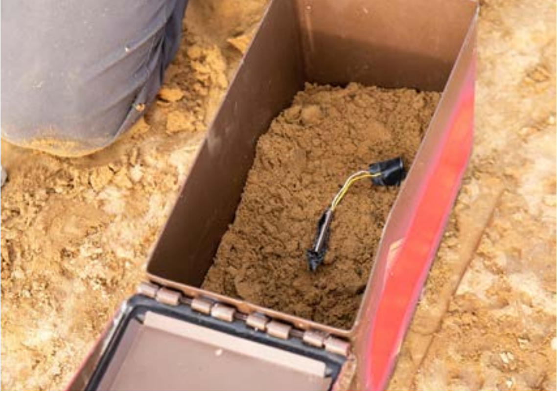
الصورة 7: وضع المفجّر في صندوق معدني صلب للوقاية من التردد اللاسلكي والحماية من الضرر
