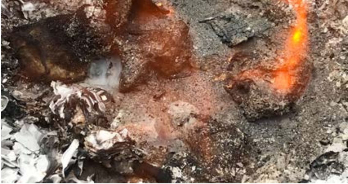
الصورة 179. بقايا حارقة مبتكرة (مكونة من الجل)، اشتعلت من جديد عند تعرضها للأكسجين في الغلاف الجوي على رماد مضطرب لمكان تجارية (المصدر: شركة بريستون للاستشارات (ش.م.))
