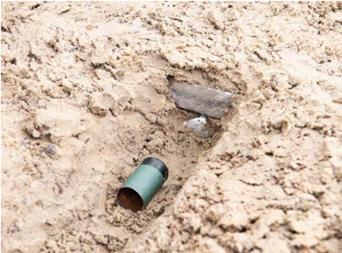
الصورة 1: شحنة جوفاء مصنوعة محليًا موضوعة لاستهداف شحنة رئيسية لعبوة ناسفة مبتكرة تحت قرص ضغط يعلوها من كلّ الجهات. باستخدام هذه التقنية، يتمكّن المشغل المعني بالتخلّص من العبوات الناسفة المبتكرة في الأعمال المتعلقة بالألغام من تفادي أيّ تفاعل مُحتمل مع مفتاح الإشعال
