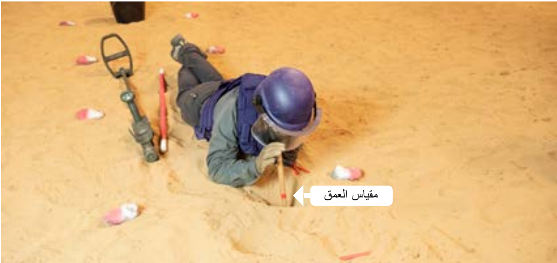
الصورة 9: يمكن التحقق من العمق المناسب للتنقيب باستخدام مقياس عمق مخصص
