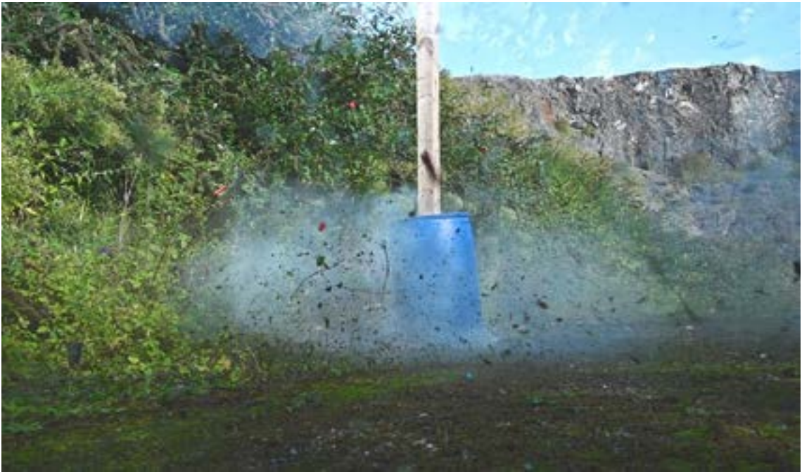
الصورة 23: توجيه زجاجة التعطيل نحو البطارية PP3 بقوة 9 فولت. يمكن ملاحظة الخلايا المعطلة في هذه الصورة
