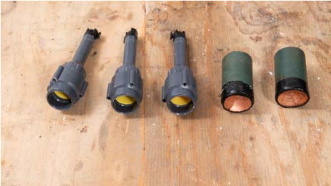
الصورة 11: ثلاث شحنات جوفاء تجارية بحجم 30 ملم قابلة للتعبئة من قِبَل المُستخدم، إلى جانب شحنتين مشكّلتين بحجم 40 ملم محليّتي الصنع
