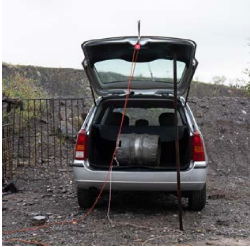
الصورة 12: تم إعداد الخطاف والحبل، وعاد المشغل المعني بالتخلص من العبوات الناسفة المبتكرة إلى نقطة السيطرة
