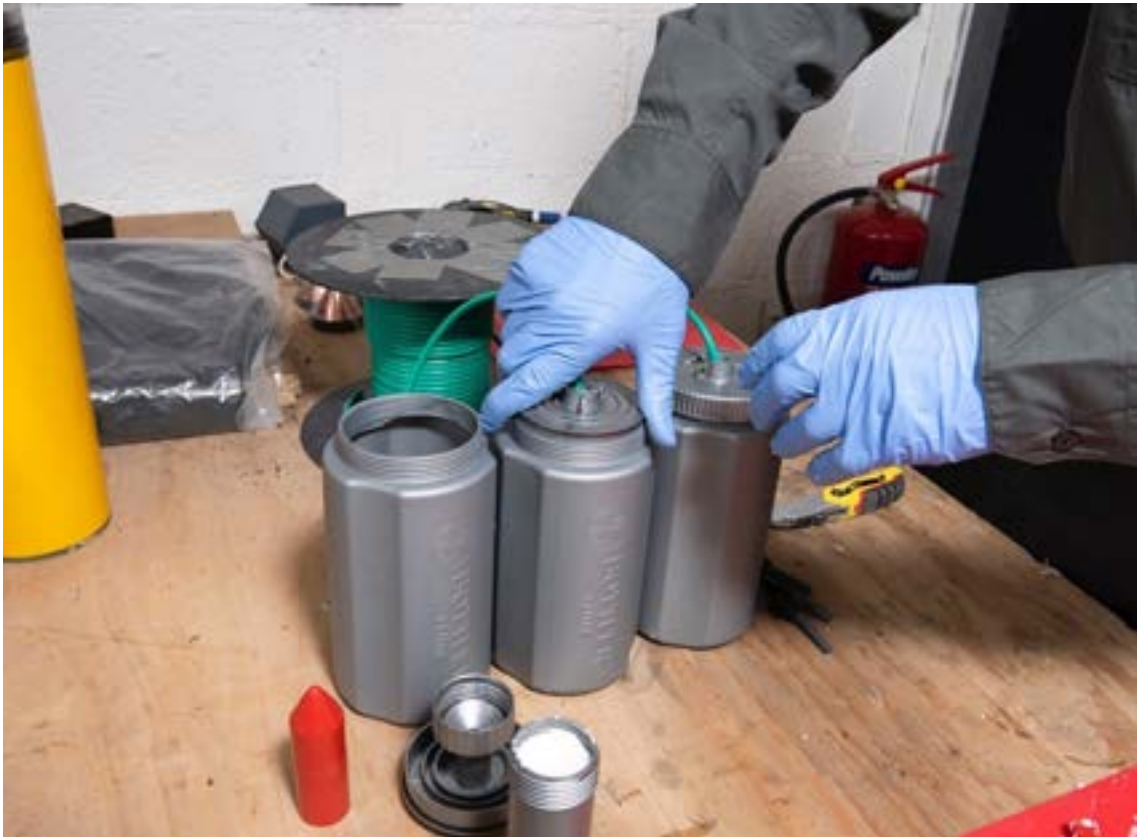
الصورة 3: إدخال الحجرة الداخلية وإحكام إغلاق الشحنة المعطّلة التجارية بواسطة الغطاء. يُضاف الماء قبل الاستخدام
