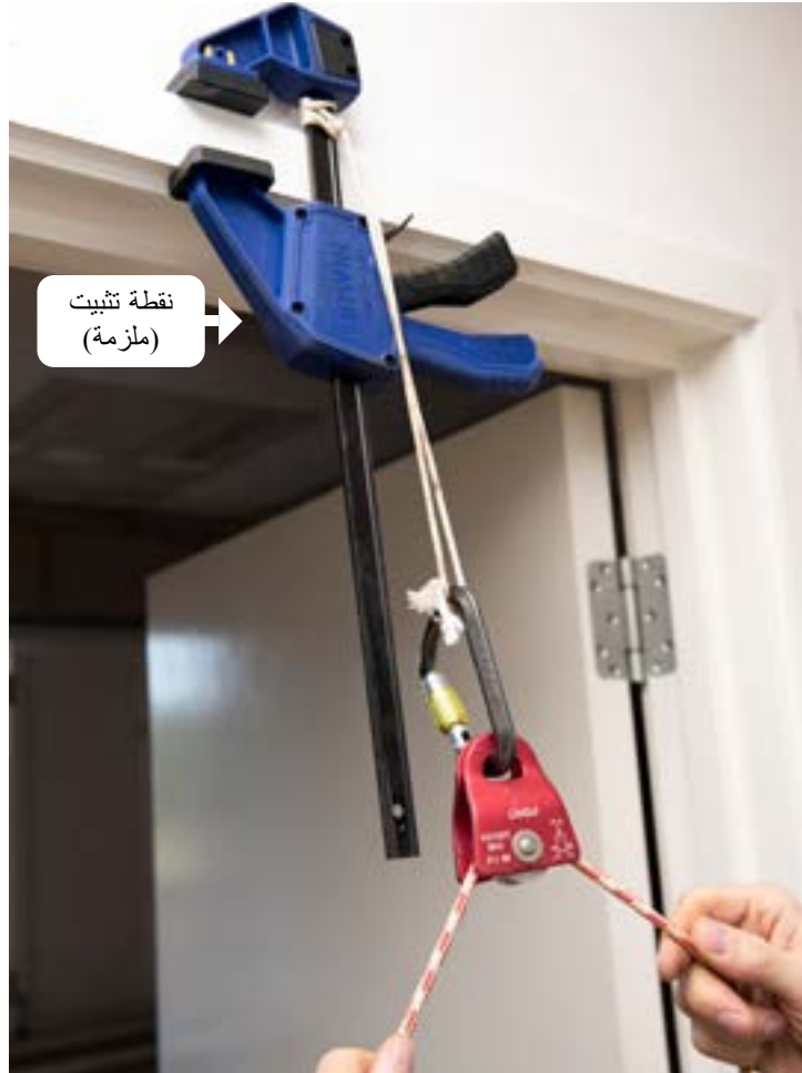
الصورة 9: استخدام الملزمة التجارية كمنقطة تثبيت لتغيير الاتجاه مع عقدة حبل بيضاء (pursik) وحلقة معدنية وبكرة
