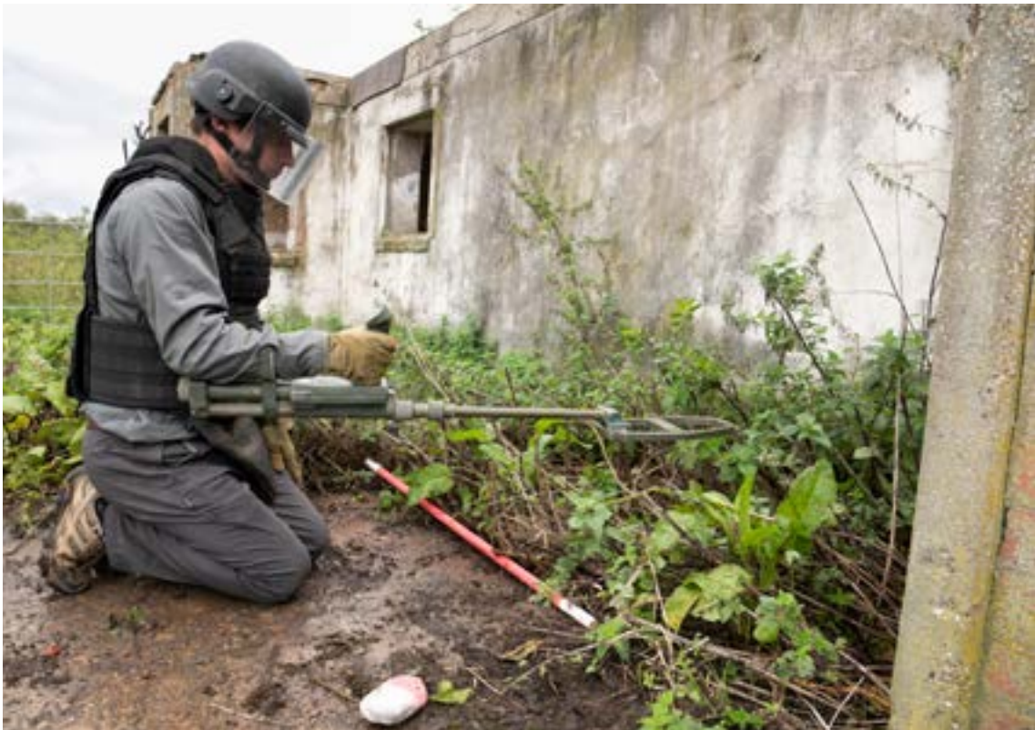
الصورة 4: عملية مسح أولية باستخدام الكاشف، مع وجود بعض النباتات التي لا يزال يجب إزالتها
