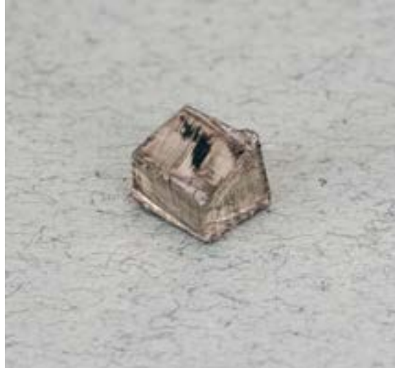
الصورة 188. ليثيوم، معدن قلوي (المصدر: قيادة الدفاع الكيميائي والبيولوجي والإشعاعي والنووي في الجيش الألماني ©)
