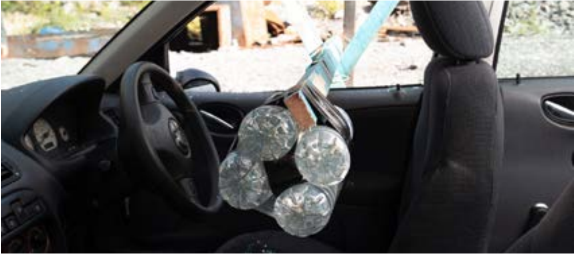
الصورة 20: معطل العبوات الناسفة المبتكرة الموضوعة في المركبات في وسط مقصورة الركاب
