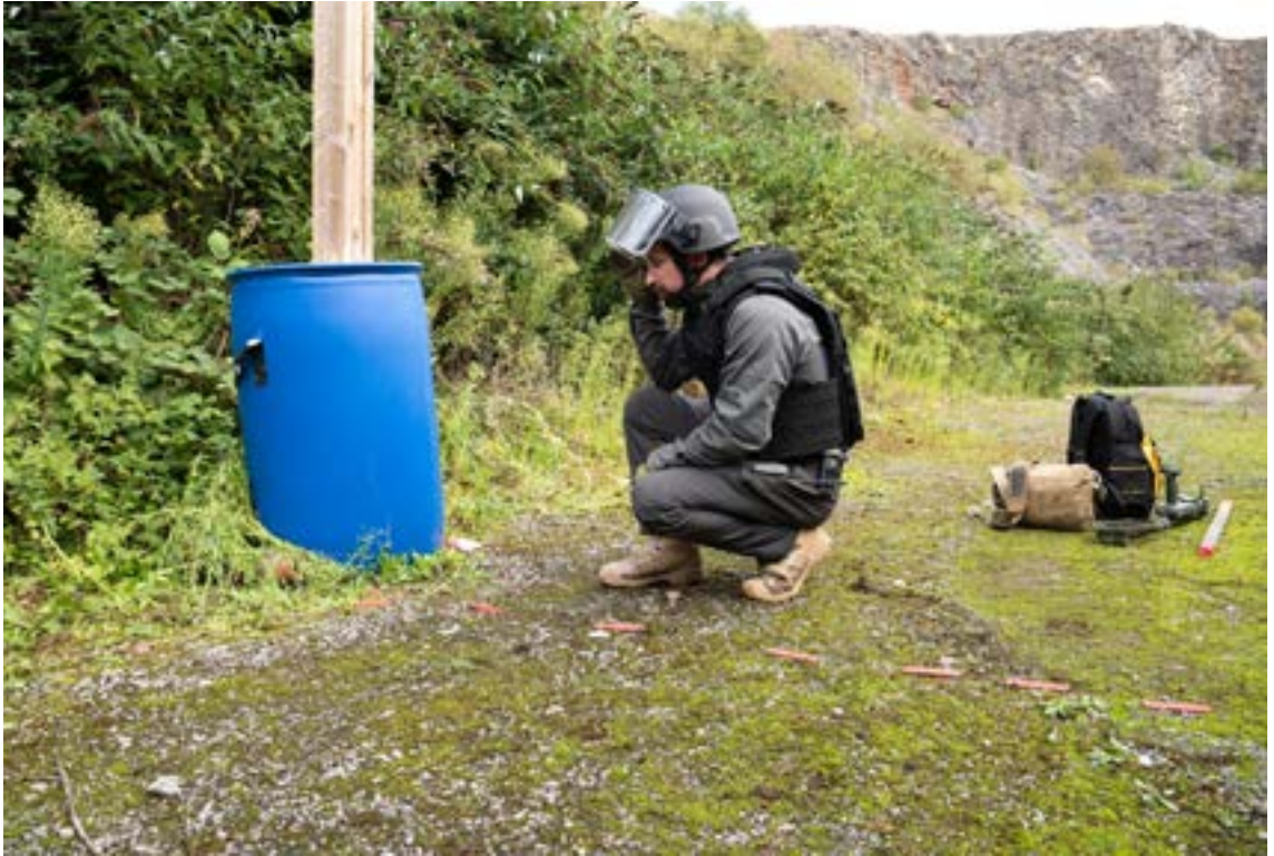
الصورة 1: المشغل المعني بالتخلّص من العبوات الناسفة المبتكرة يفحص العبوة الناسفة المبتكرة من المنطقة التي تمّ تطهيرها مسبقاً. تمّ رفع القناع لزيادة المراقبة البصرية
