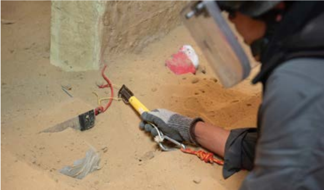
الصورة 20: وضع القاطع عن بُعد جزئياً مقابل سلك التفجير. (الكابل الأحمر هو أداة الشد)
