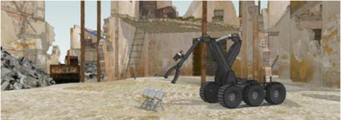
الصورة 6: مركبة عاملة عن بُعد تضع من مسافة بعيدة مصفوفة من الشحنات الجوفاء لاستهداف عبوة ناسفة مبتكرة مطمورة
