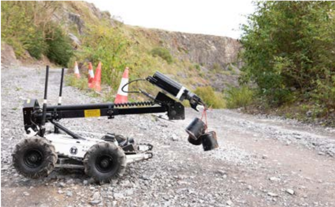
الصورة 5: مركبة يتم تشغيلها عن بُعد وتحرك مجموعة مقذوفات متفجرة ملاحظة: يحافظ العامل على توجيه القذيفة المتفجرة في اتجاه آمن. سلك التفجير موجود في أخدود في فكي المناور ولا يمسه المناور
