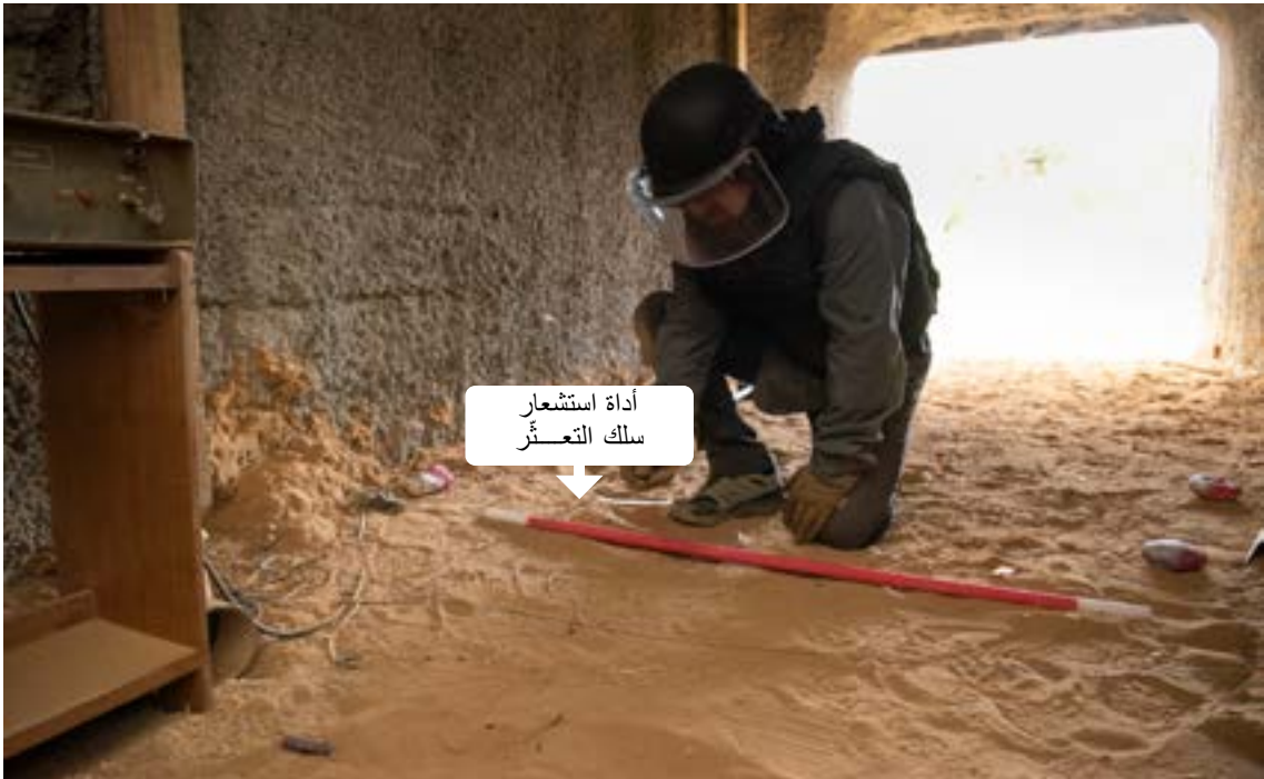
الصورة 9: استخدام أداة استشعار أسلاك التعنُّر في ممر لا يصله الضوء الطبيعي بشكل كبير
