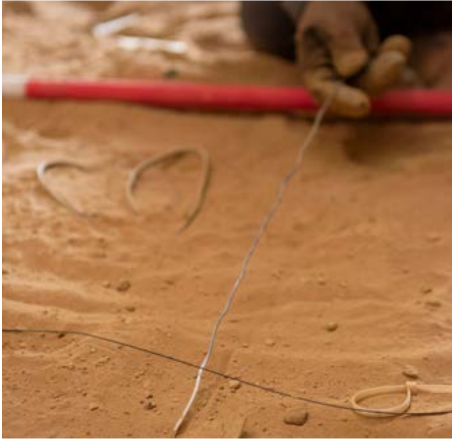
الصورة 10: أداة استشعار أسلاك التعثر التي تمرّ عبر الطبقات العليا من الرمل لتحديد موقع سلك التعثر المتراخي. الانتباه إلى أنّ أداة الاستشعار في هذه الصورة لا تلمس السلك
