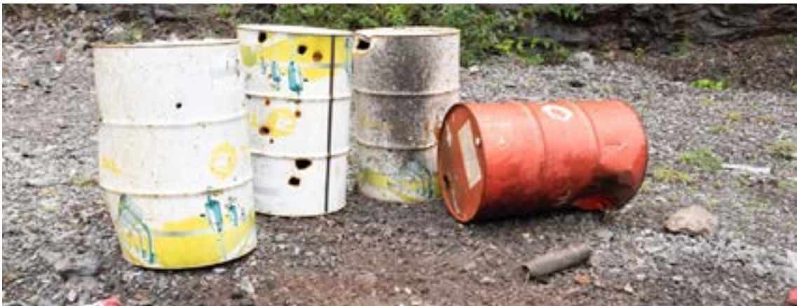
الصورة 9: الأثر ما بعد التعطيل. يمكن ملاحظة كيفية تحرك المقذوفة وبرميل النفط نتيجة قوة زجاجة التعطيل
