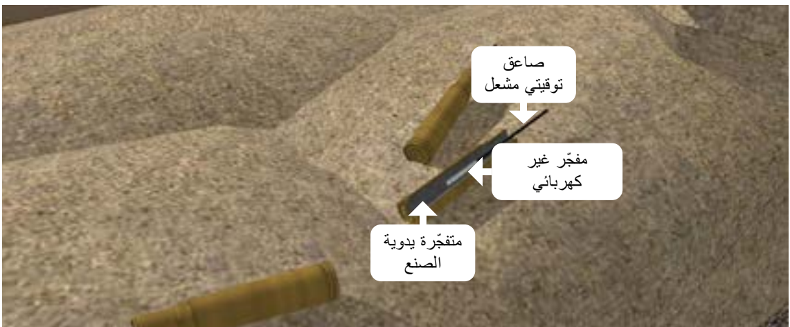
الصورة 11: صورة تُوضح تشريحاً بالعرض لعبوة ناسفة مبتكرة مشعلة يتم إلقاؤها باليد وتستخدم ذخيرة خرطوش كحاوية
