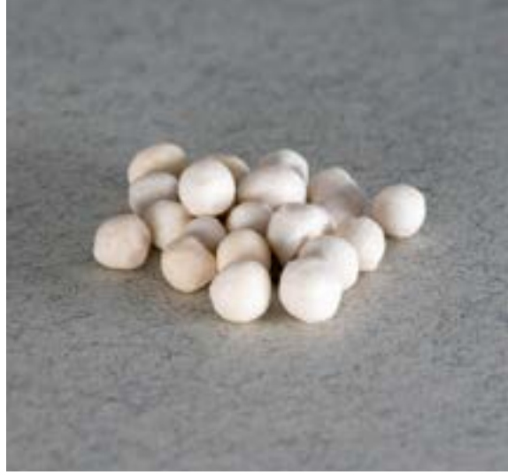
الصورة 151. نترات أمونيوم الكالسيوم مصنوعة على شكل حبيبات صغيرة (المصدر: قيادة الدفاع الكيميائي والبيولوجي والإشعاعي والنووي في الجيش الألماني ©)
