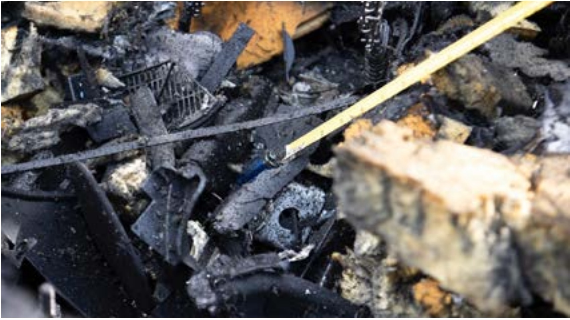
الصورة 26: مقياس شريطي يُشير إلى مصدر الطاقة من الحزمة القابلة للتحكم عن بُعد. يمكن رؤية بقايا حاوية الحزمة القابلة للتحكم عن بُعد تحت مصدر الطاقة
