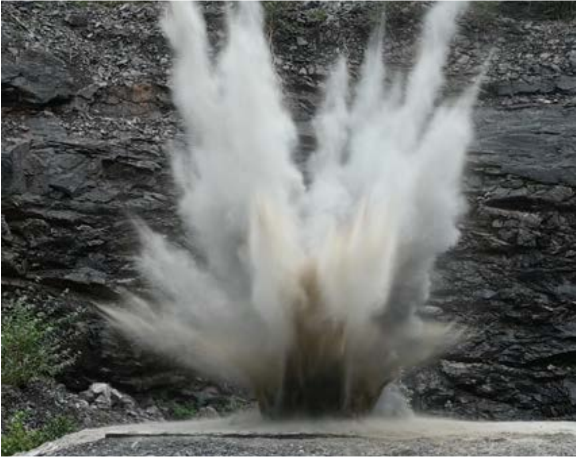
الصورة 1: عملية تدمير في الموقع لـ 800 غ من المتفجرات اليدوية الصنع المؤلفة من مركب نترات الأمونيوم ومسحوق الألومنيوم (ANAL) مع شحنة تفجير شديدة الانفجار بوزن 100 غ
