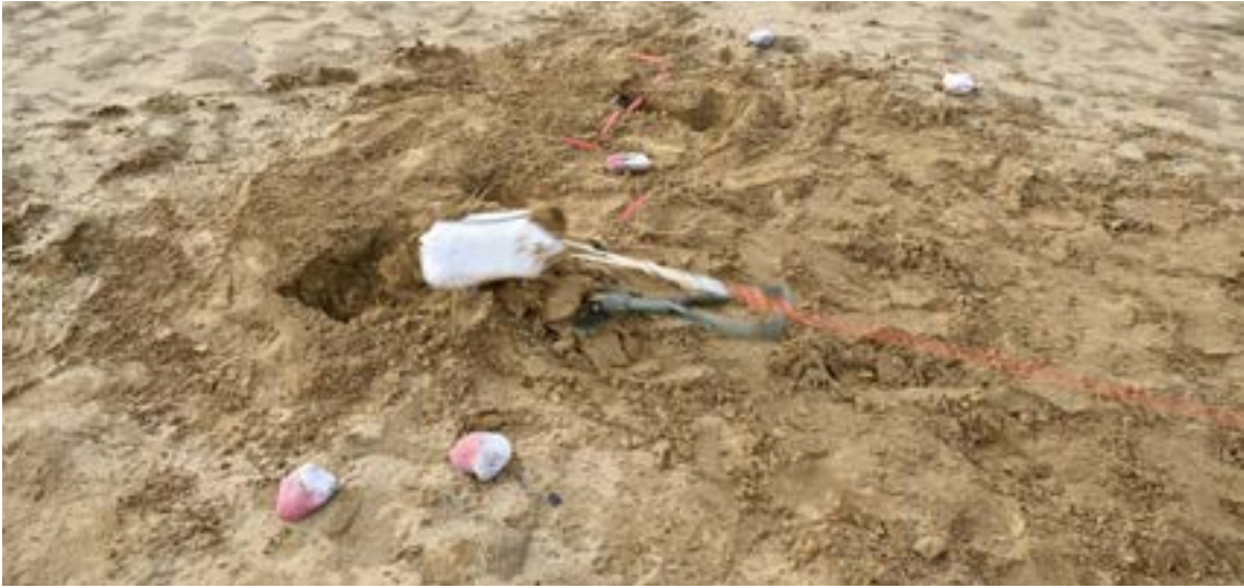
الصورة 10: استخدام المجرفة لإنشاء نقطة محورية مرتفعة، ما يُساعد في إزالة الشحنة الرئيسية من خلال رفعها وسحبها
