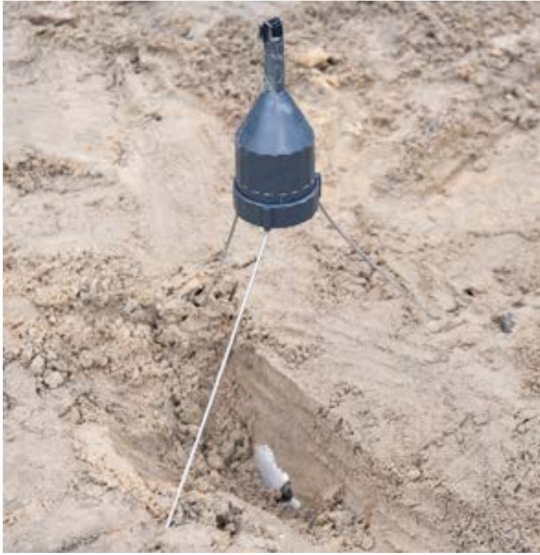
الصورة 3: شحنة جوفاء بحجم 65 ملم موضوعة لاستهداف شحنة رئيسية مغلقة بحاوية معدنية مطمورة تحت عمق 100 ملم من الرمل. تتوفر مسافة 200 ملم بين الشحنة الجوفاء وسطح الرمل. تم إبراز الشحنة الرئيسية من أجل التقاط الصورة
