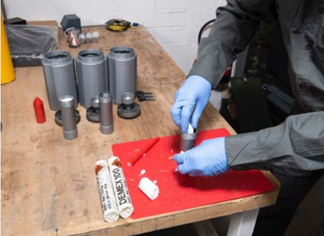
الصورة 1: تعبئة المتفجّرات البلاستيكية في الحجرة الداخلية للشحنة المعطّلة التجارية
