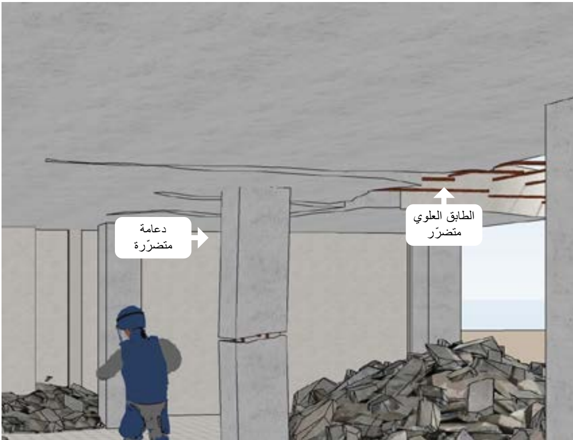
الصورة 7: تُظهر الصورة مؤشرات مثل الأضرار التي لحقت بالطابق العلوي والدعامة - هل السلامة الهيكلية مهدّدة؟
