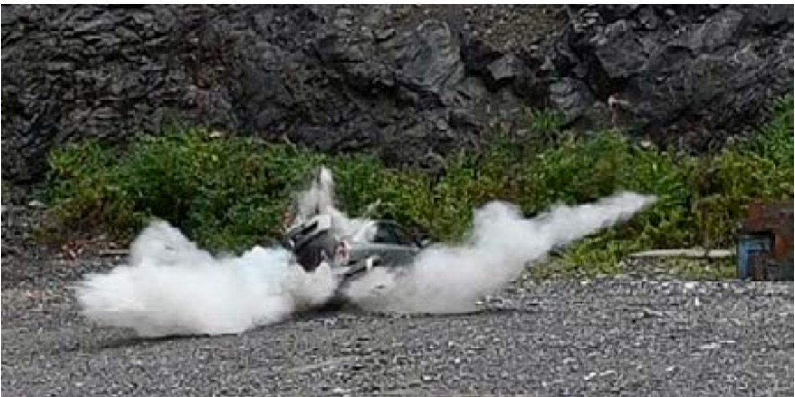
الصورة 32: يمكن ملاحظة كيف قمع الماء الوميض الناجم عن التفجير. يسهم هذا الأمر في التخفيف من خطر اندلاع حريق في المركبة
