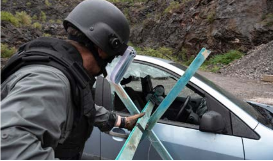
الصورة 8: استخدام حامل مبتكر من أجل تعليق معطل العبوات الناسفة المبتكرة الموضوعة في المركبات في وسط مقصورة الركاب
