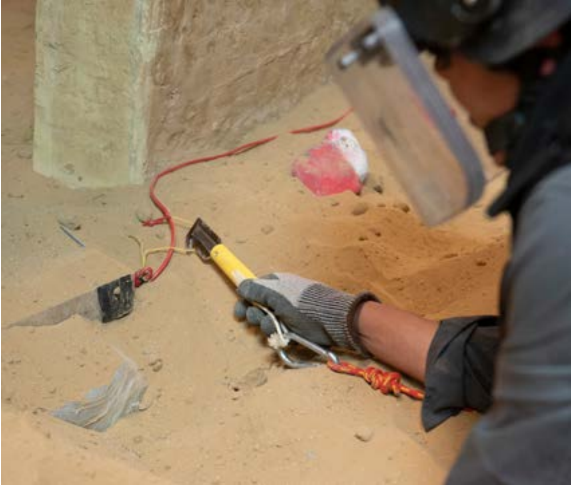
الصورة 14: وضع قاطع من طراز J Knife لقطع السلك الكهربائي عن بُعد جزئياً. وقد تشكل هذه التقنية الخيار الأولي عند تعذر الوصول إلى الطاقة
