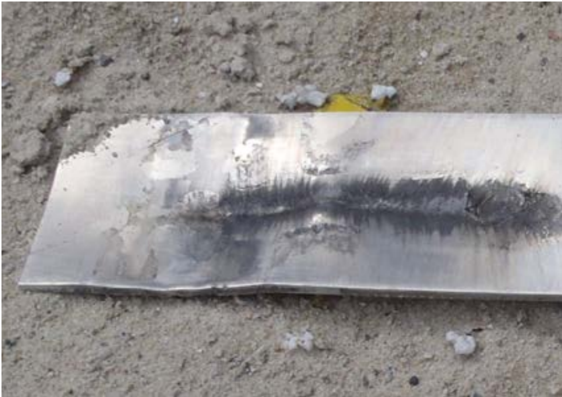
الصورة 15. آثار مُفجّر مبتكر (مملوء بمادة بيروكسيد الأستون) على صفيحة من الألومنيوم (المصدر: شركة بريمستون الاستشارية المحدودة ©)
