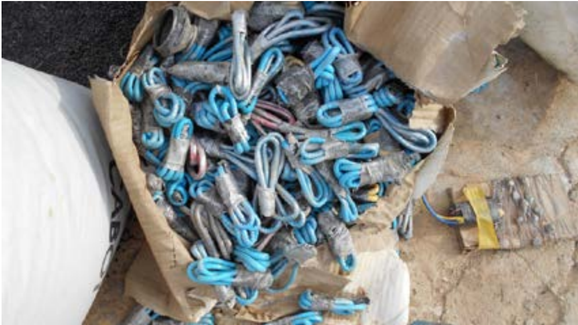
الصورة 17. دوافع تفجير لشحنات رئيسية من العبوات الناسفة يدوية الصنع، مصنوعة من حبل تفجير مبتكر (المصدر: المؤسسة السويسرية لنزع الألغام ©)
