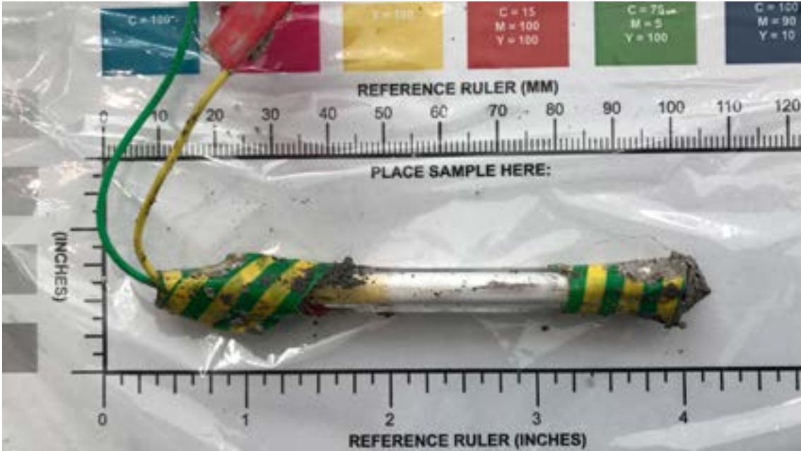
الصورة 189. مفجر بدء تفجيره كهربائيًا باستخدام متفجرات مبتكرة مصنوعة من الكلورات والبيروكسيد العضوي (المصدر: شركة بريمستون للاستشارات (ش.م.))
