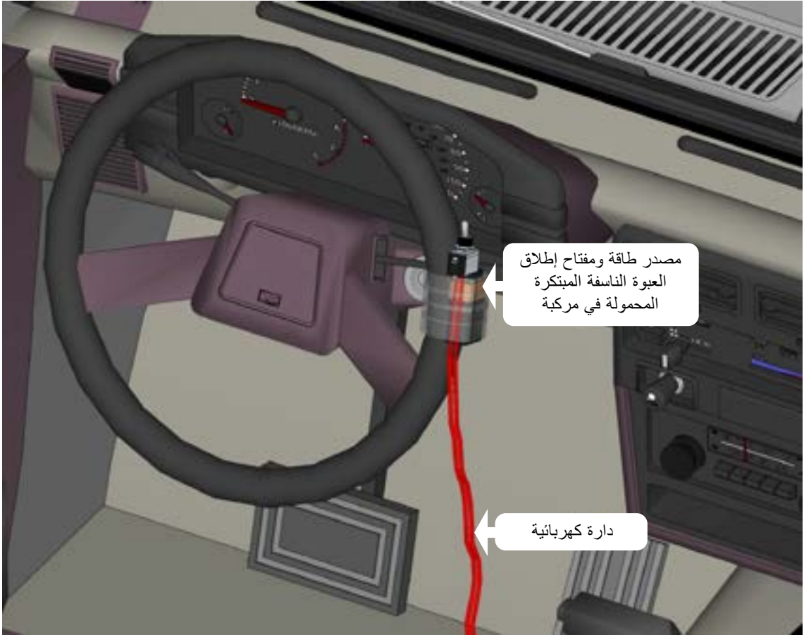
الصورة 11: صورة لمفتاح إطلاق العبوة الناسفة المبتكرة المحمولة في مركبة، مربوط بعجلة القيادة
