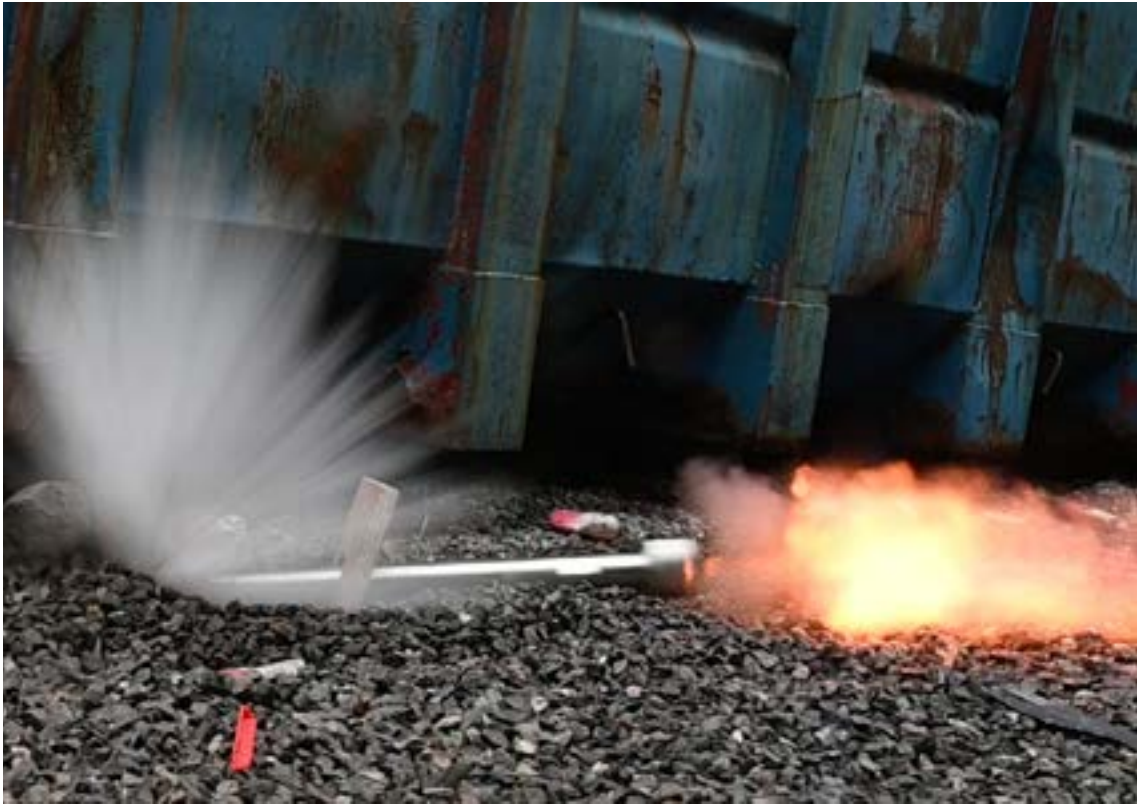
الصورة 4: صورة تُظهر برميلاً مُستخدمًا كجهاز تعطيل لإبطال مفعول عبوة ناسفة مبتكرة
