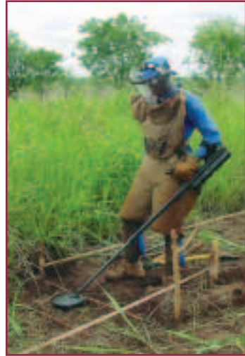
Un desminador provisto de un equipo de protección personal utilizando un detector de metales de uso corriente.
