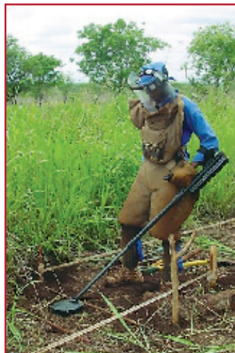
Специалист по разминированию, снабженный защитным снаряжением и стандартным металлоискателем
