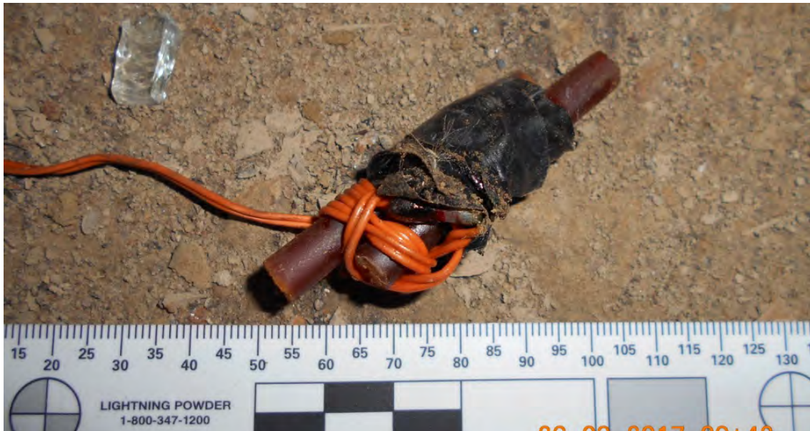
Image 190. Dispositif d'allumage de roquette improvisé (source: FSD ©)
