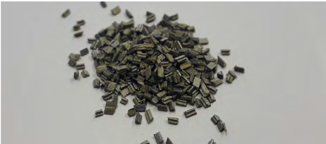
Image 19. Propulseur à base de nitrocellulose (source : Commandement défense CBRN de la Bundeswehr ©)
