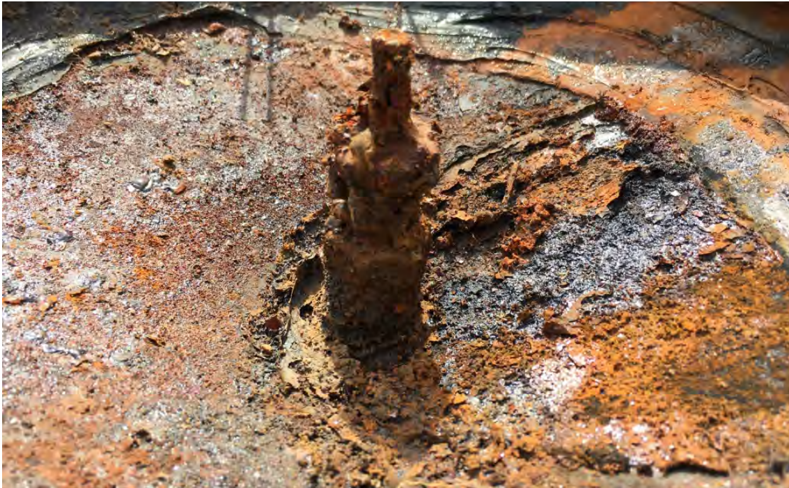
Image 116. Percuteur armé d'un VS-500 corrodé par le temps (source: FSD ©)
