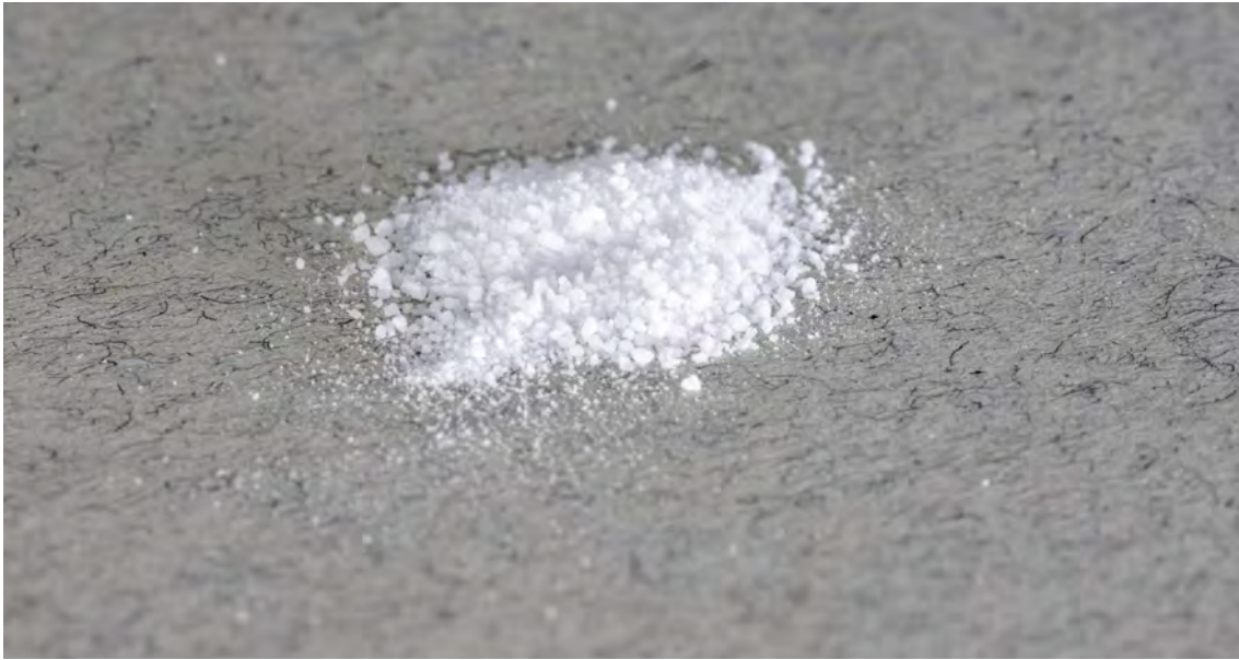
Image 134. Mélange nitrate d'ammonium-chlorate de potassium. Remarque: ce mélange a été traité dans des conditions de laboratoire (source: Commandement défense CBRN de la Bundeswehr ©)
