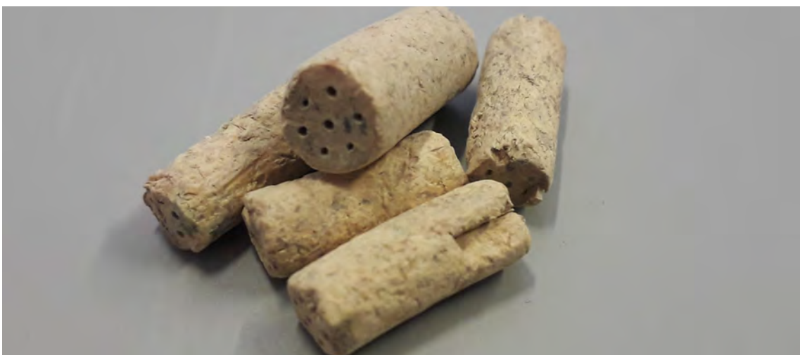
Image 20. Autre exemple de propulseur à base de nitrocellulose. Percer des trous augmente la surface du granule et donc la combustion (source : Commandement défense CBRN de la Bundeswehr ©)
