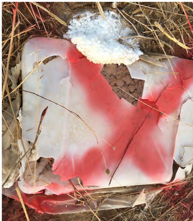
Image 119. Les effets du vieillissement: nitrate d'ammonium recristallisé (source : FSD ©)
