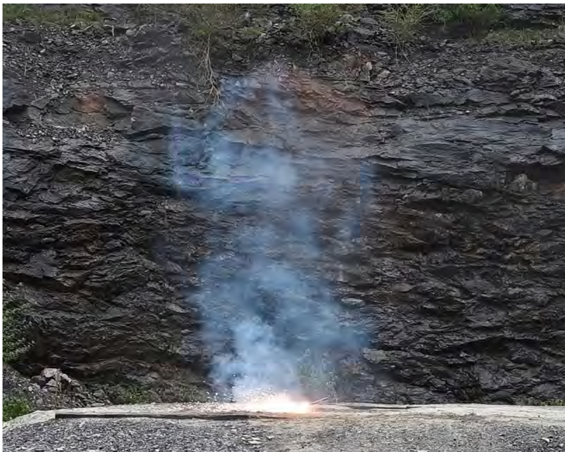
Image 1. Utilisation d'une torche pyrotechnique / lance thermite sur une charge principale contenant des explosifs artisanaux
