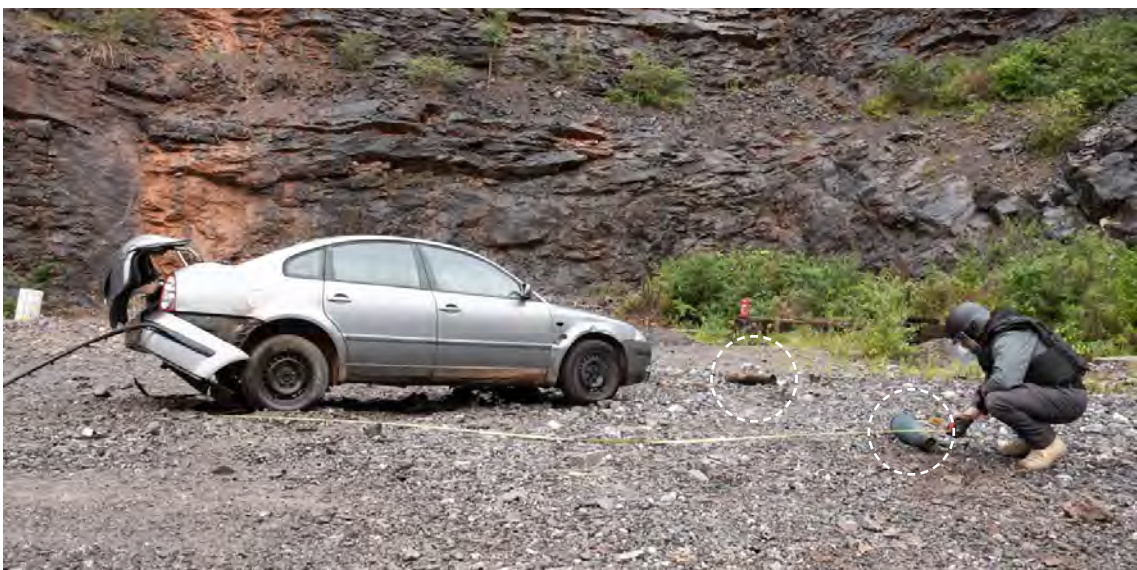
Image 38. Emplacement des deux projectiles de 155 mm après le déclenchement de l'extracteur d'EEL placé dans un véhicule
