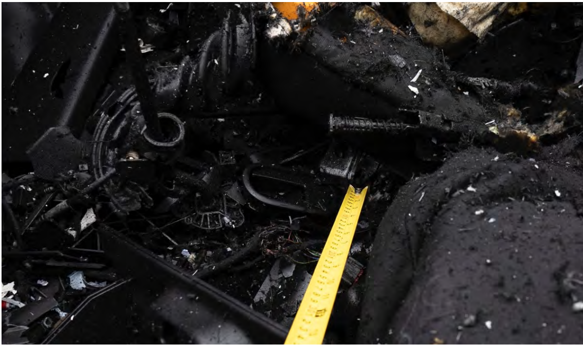
Image 16. Le mètre ruban pointe vers la batterie du téléphone mobile à proximité de l'emplacement initial du bloc RC
