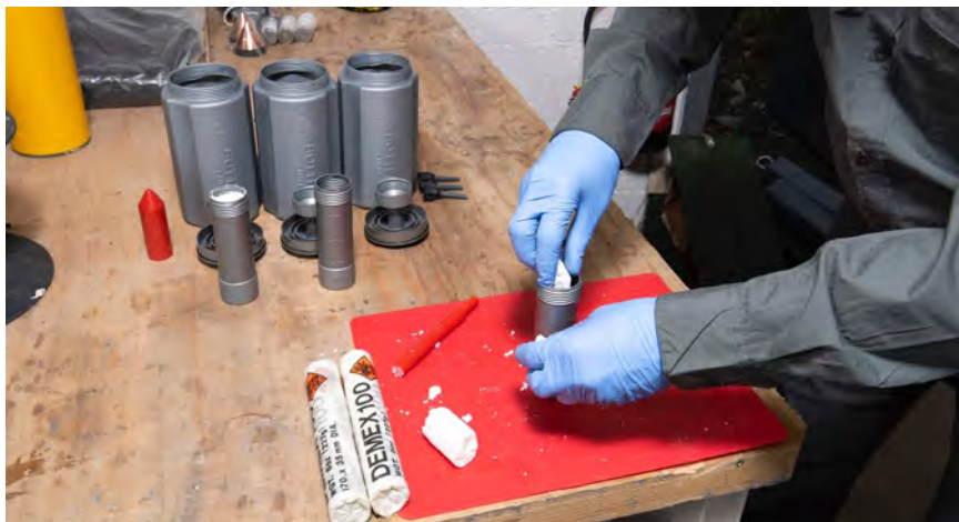
Image 1. Chargement d'explosifs plastiques dans le cylindre intérieur d'un disrupteur à bouteille disponible sur le marché
