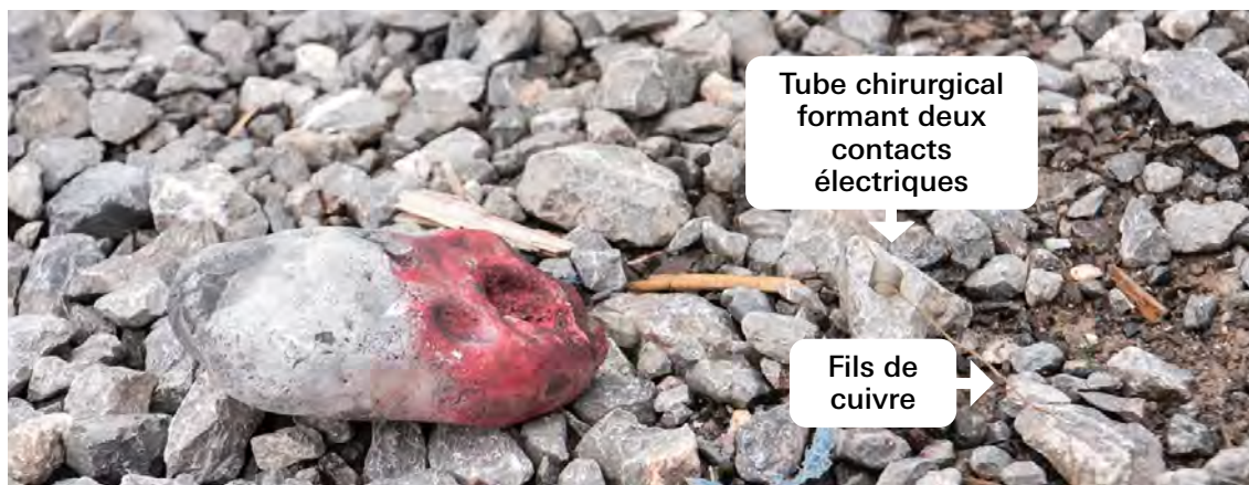
Image 6. Exemple de déclencheur à fil d'écrasement. Note : ces deux fils de cuivre seraient recouverts d'un vernis isolant, qui est éliminé là où il est enveloppé autour du tube chirurgical pour former deux contacts électriques
