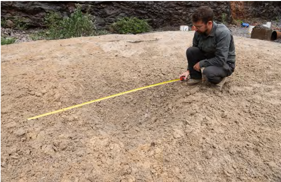
Image 4. Cratère provoqué par une détonation de haute intensité durant des essais
