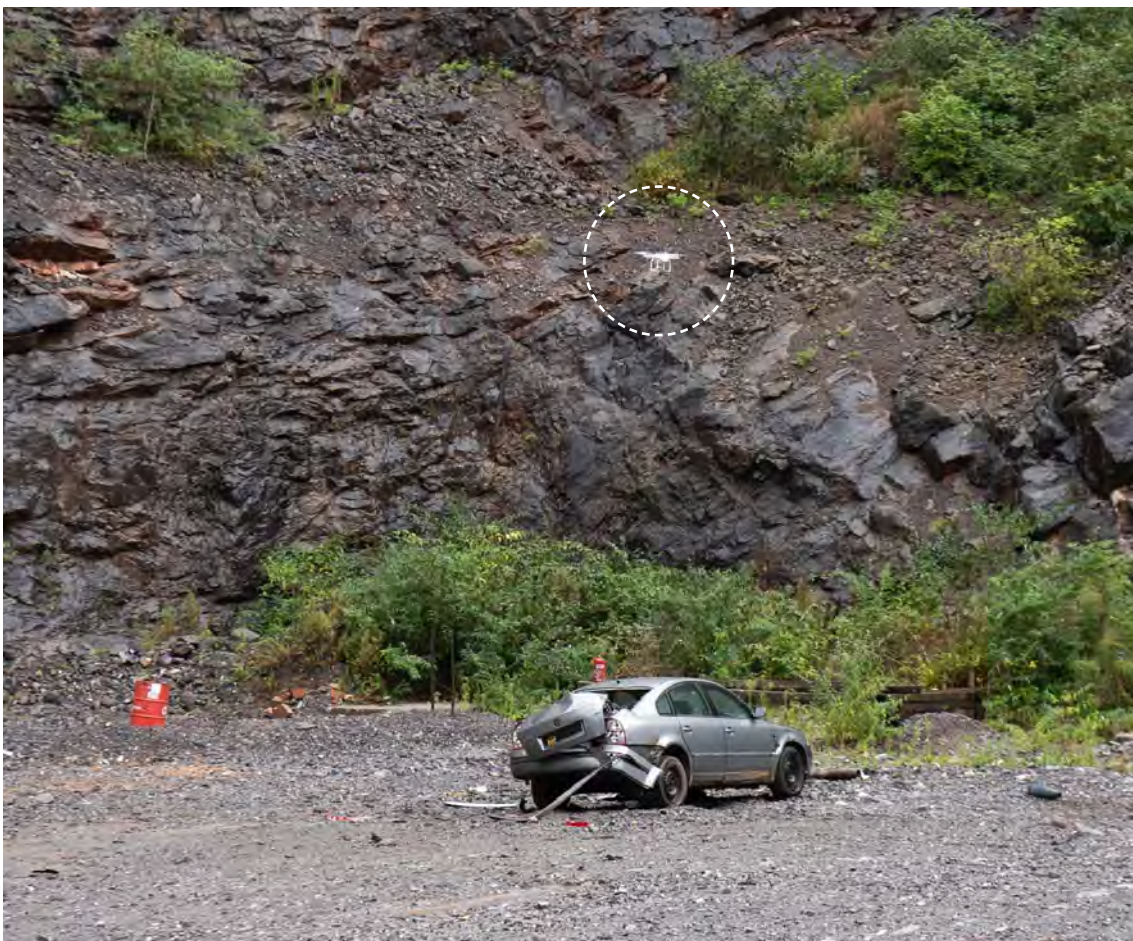
Image 3. Véhicule aérien sans pilote confirmant que l'extracteur d'EEI placé dans un véhicule a fonctionné et utilisant son champ de vision élargi depuis une position aérienne pour localiser l'EEI ou ses composants, puis vérifier si la disruption est un succès
