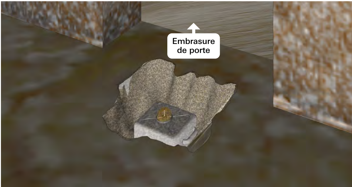
Image 42. EEI déclenché par la victime mécanique (pression) en position
