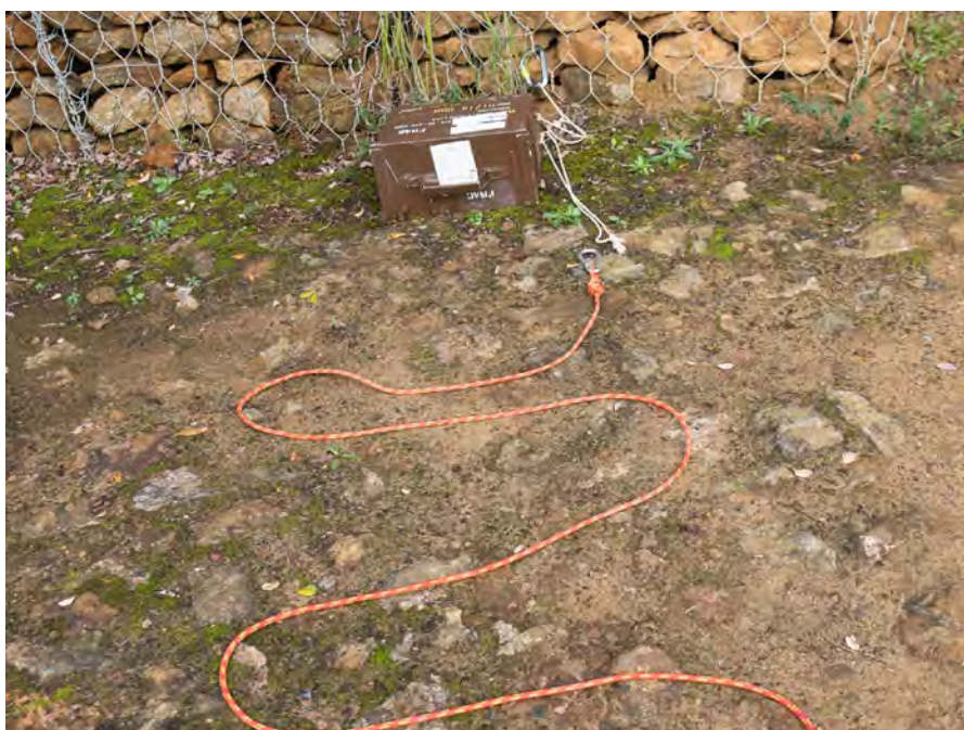
Image 1. Kit de traction H&L prêt à être relié à la corde principale par une élingue. Notez la corde principale détendue et une attache fixée à un point d'ancrage pour provoquer l'ouverture du conteneur
