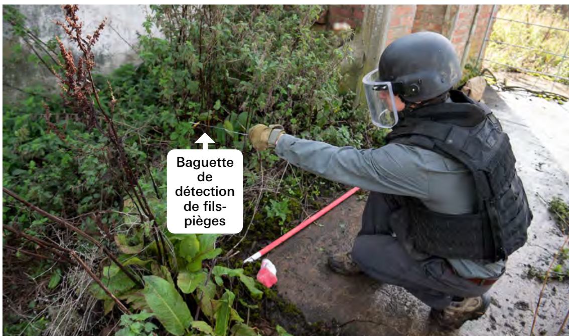
Image 2. Utilisation d'une baguette de détection de fils-pièges pour faciliter la fouille visuelle dans la couche supérieure de végétation
