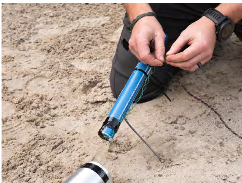
Image 2. Lance thermite placée pour induire le brûlage d'une charge principale enveloppée d'une fine pellicule de métal. Notez comment la lance a été placée à l'arrière pour éviter le cordeau détonant
