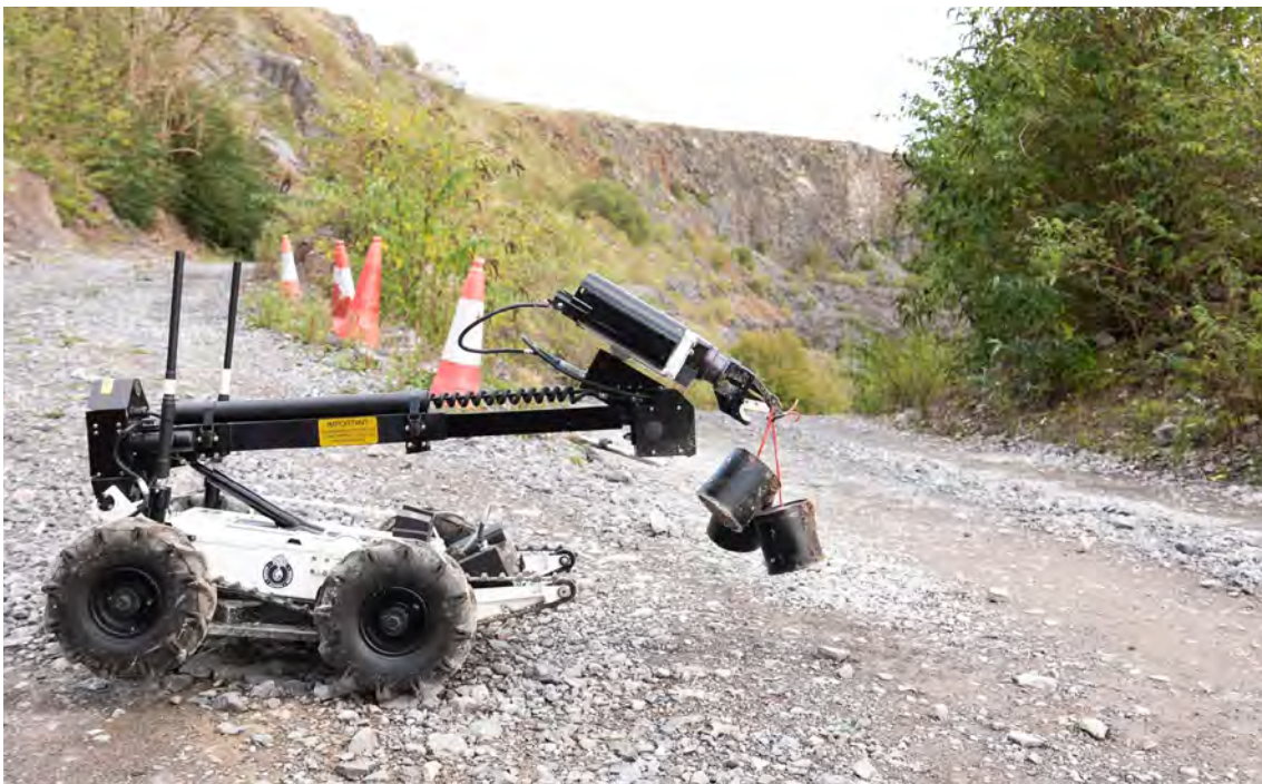
Image 5. ROV déplaçant une batterie de PFE. Note : l'opérateur laisse les PFE pointer dans une direction sûre. Le cordeau détonant est logé dans une rainure de la mâchoire du manipulateur et n'est pas serré par l'engin
