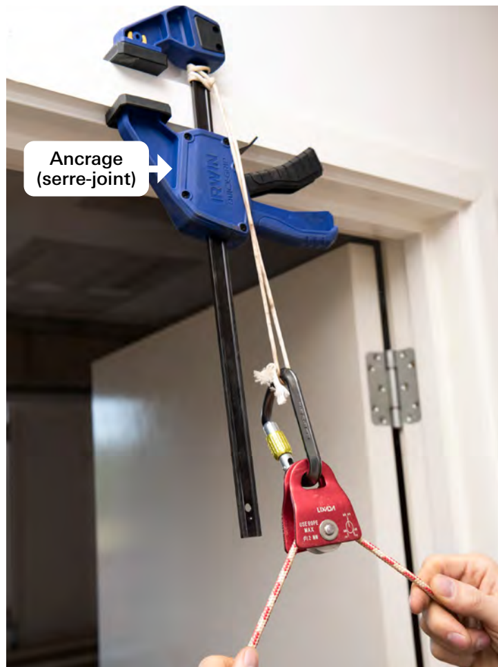
Image 9. Serre-joint grand public utilisé comme dispositif d'ancrage pour les changements de direction muni d'une boucle de cordeau prusik blanche, d'un mousqueton et d'une poulie
