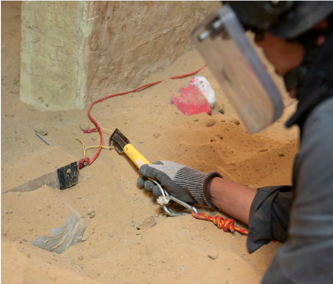
Image 14. Placer un couteau coupe-sangle pour sectionner de façon semi-éloignée un fil électrique. Cette technique peut devenir la principale option lorsque l'accès à des matières énergétiques est limité
