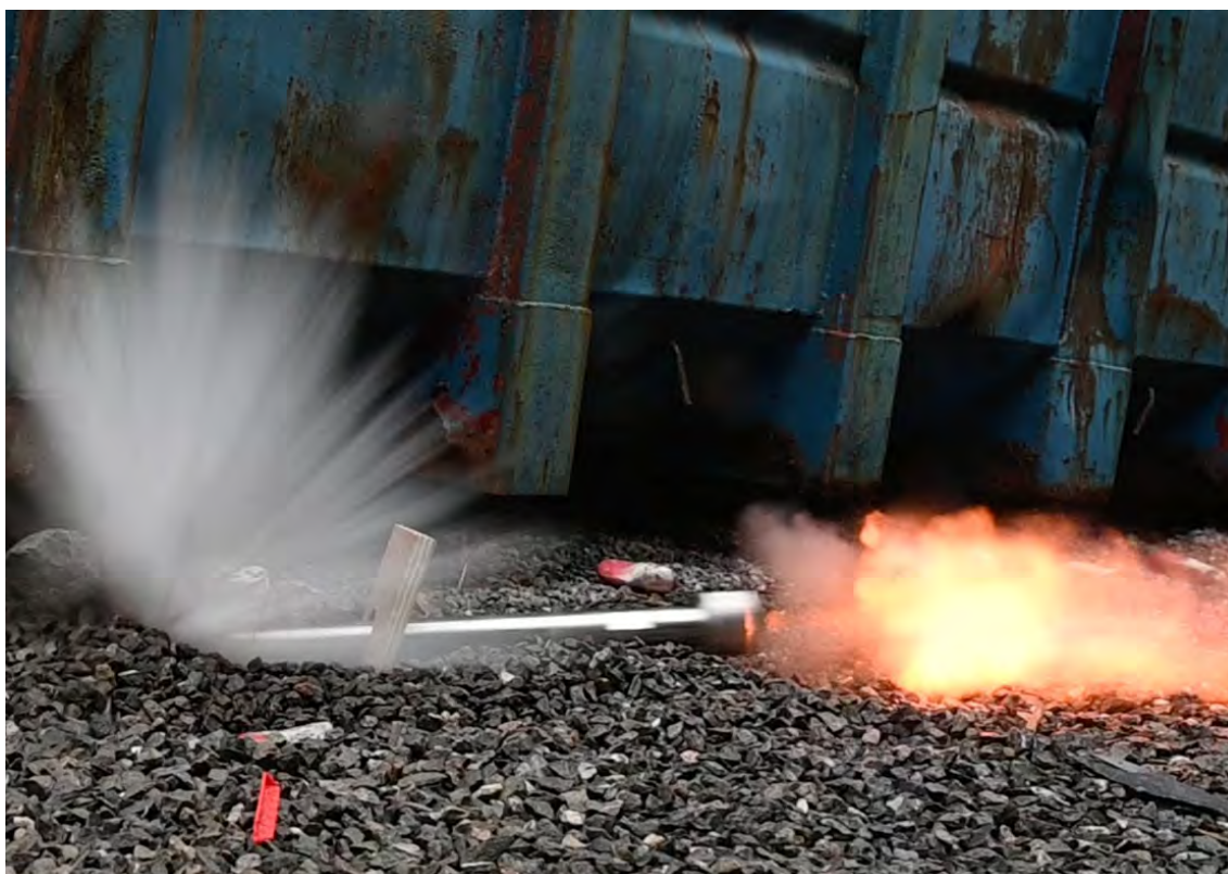
Image 4. Image d'un disrupteur à canon utilisé pour neutraliser un EEI
