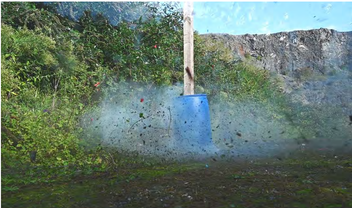
Image 23. Le disrupteur à bouteille est positionné contre la batterie PP3 9V. On aperçoit les cellules éclatées sur cette image
