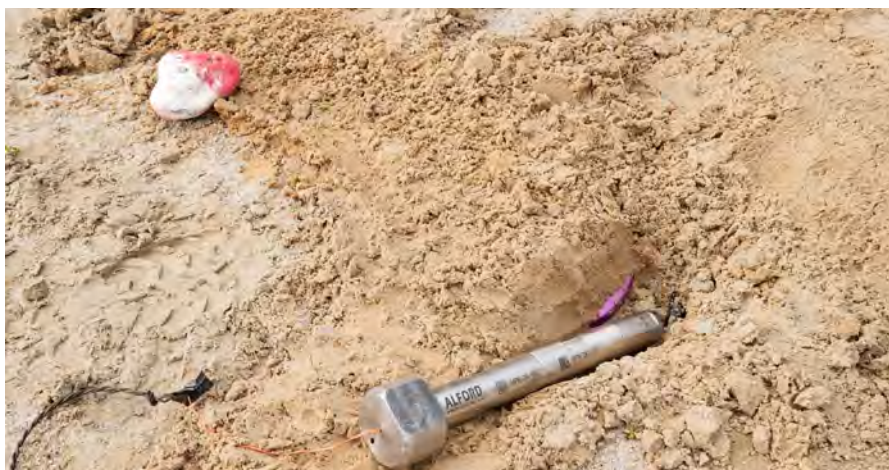
Image 4. Disrupteur à canon ciblant une source d'alimentation enfouie découverte lors d'une fouille du bout des doigts. L'angle naturel de la tranchée excavée est utilisé pour placer le disrupteur à canon
