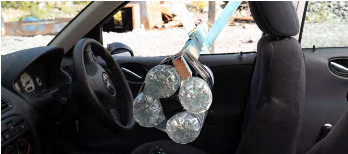
Image 20. Disrupteur d'EEL placé dans un véhicule au centre de l'habitacle
