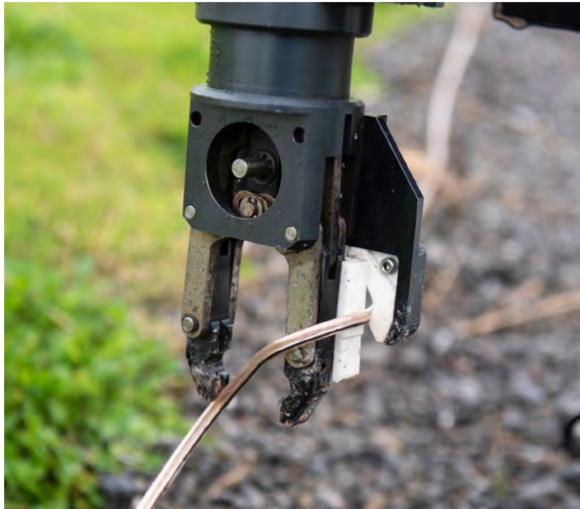
Image 4. ROV sectionnant une liaison électrique de façon semi-éloignée
