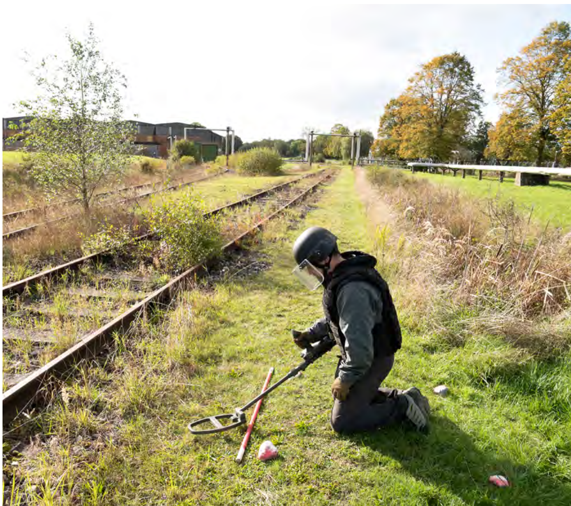
Image 3. Dans cet exemple, la menace que représentent les fils-pièges est écartée et l'employé chargé de la fouille n'utilise qu'un détecteur de métaux pour rechercher des EEI enfouis
