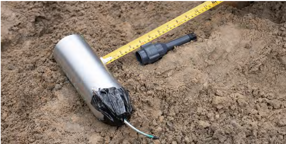
Image 8. Charge creuse dotée d'un cône de formation de jet en magnésium rempli avec 50 g d'explosifs Brisants (DEMEX) et placée à une distance de sécurité de 75 mm de la charge principale d'un EEI abandonné
