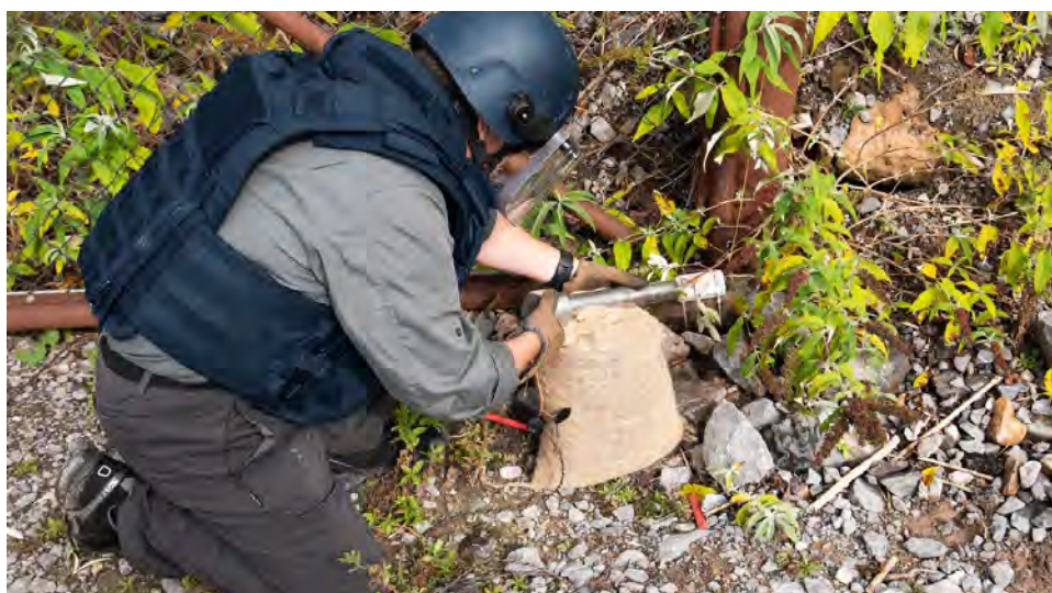
Image 6. Opérateur EEI utilisant un sac de sable comme support improvisé pour mettre en place un disrupteur à canon ciblant un ancien EEI
