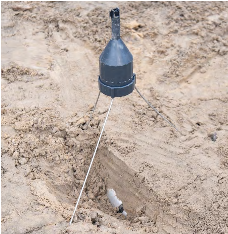
Image 3. Charge creuse de 65 mm placée pour cibler une charge principale à enveloppe métallique enfouie sous 100 mm de sable. Une distance de sécurité de 200 mm est appliquée entre la charge creuse et la surface du sable. La charge principale est exposée pour les besoins de l'image
