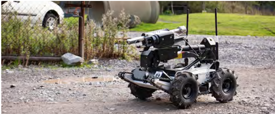
Image 1. Véhicule actionné à distance (ROV) équipé d'un disrupteur à canon, d'un manipulateur et d'une pince coupante
