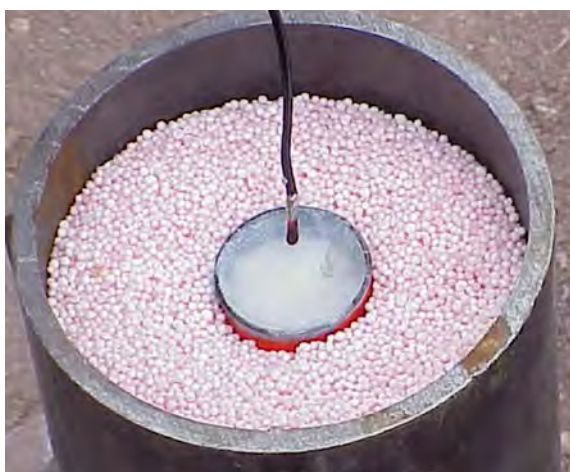
Image 142. Nitrate d'ammonium-fioul avec booster de HMTD (source : BCL ©)
