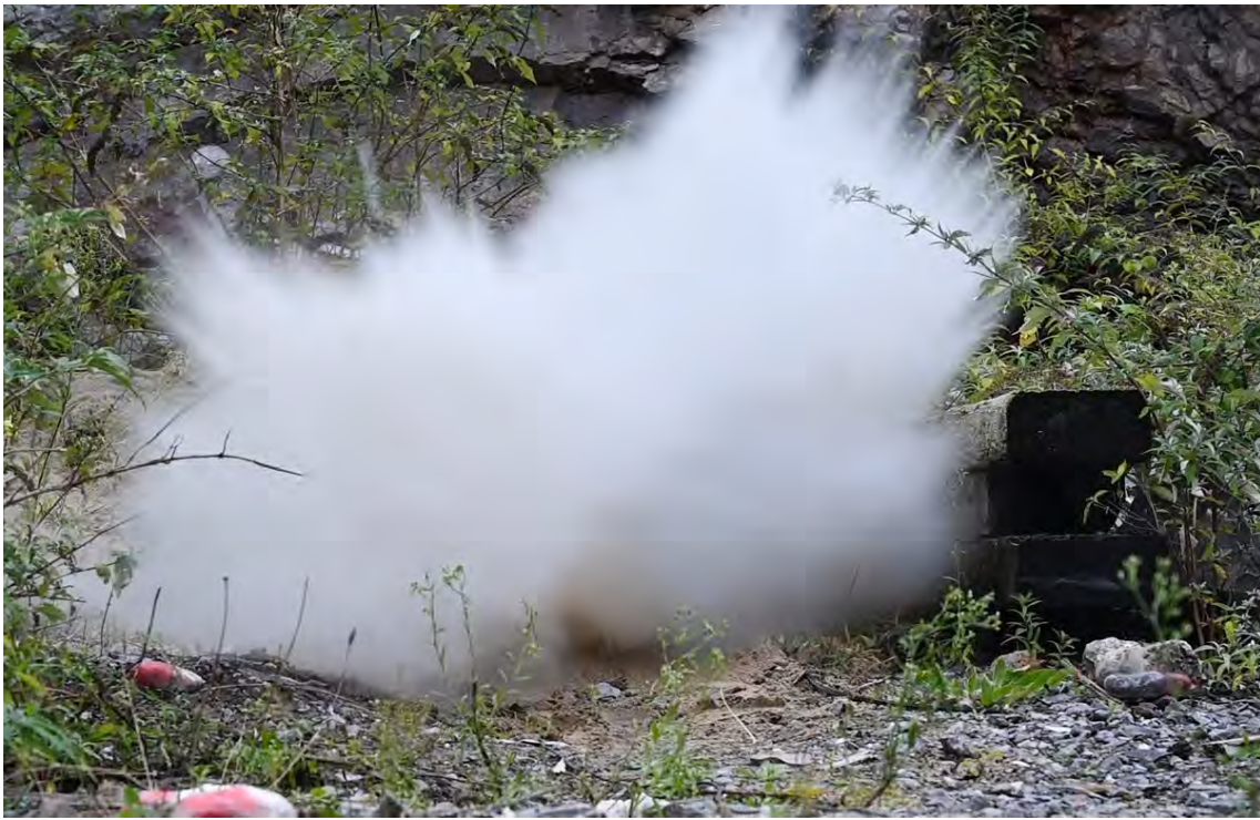
Image 18. À mesure que l'onde de choc s'amplifie, l'eau en expansion supprime l'effet de chaleur et le flash de la détonation
