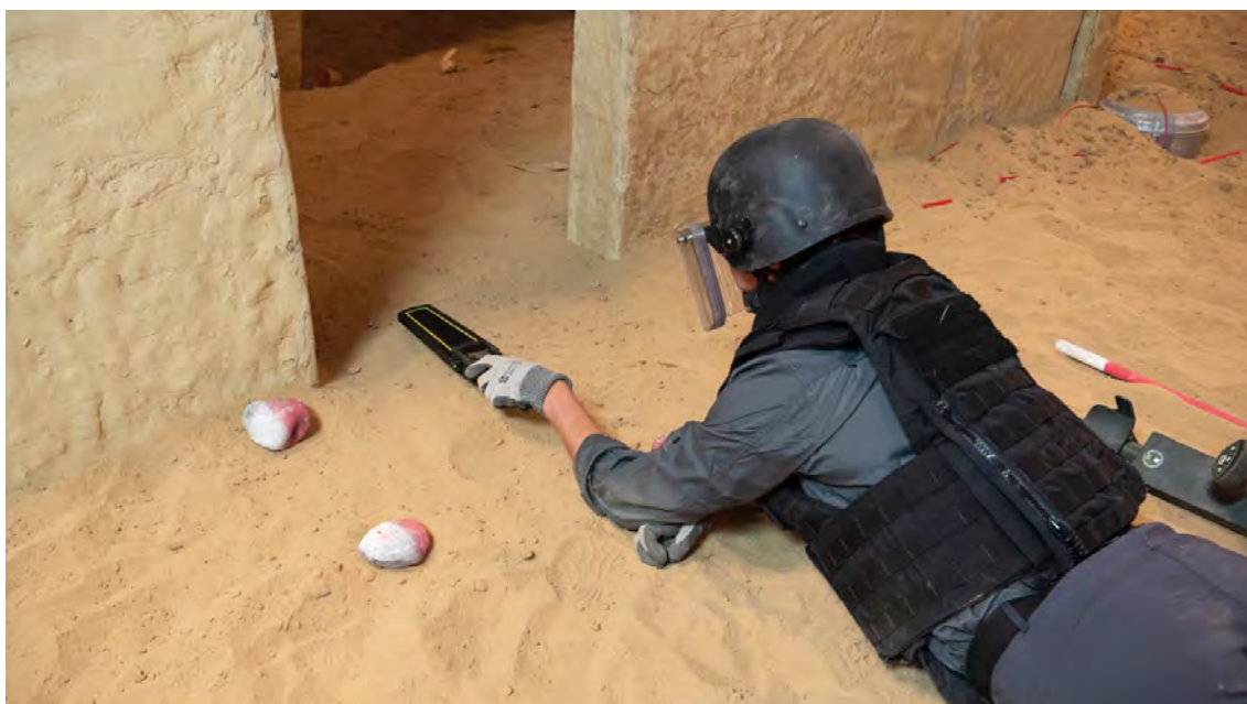
Image 17. Un détecteur de métaux portatif est utilisé pour délimiter de façon plus précise les composants sous la surface du sol
