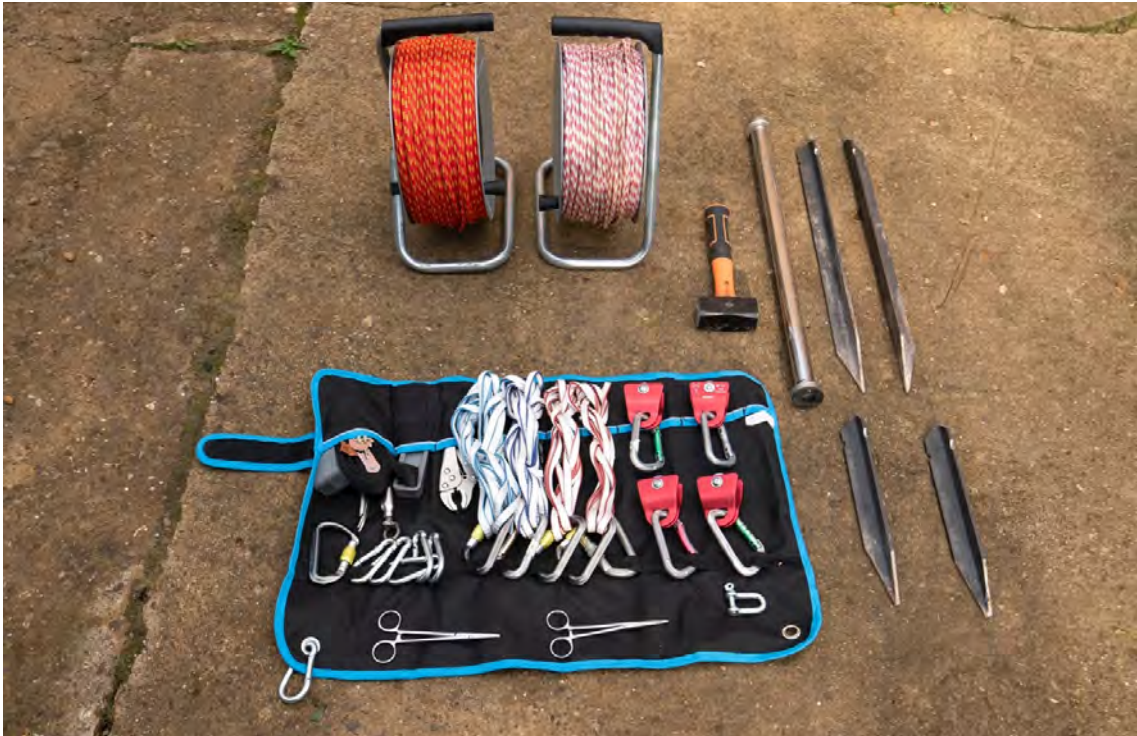
Image 1. Kit H&L produit localement. Chaque article a été acheté localement pour constituer un kit complet. Remarquez la qualité / fiabilité de l'outillage pour éviter tout(e) problème / casse superflu(e)
