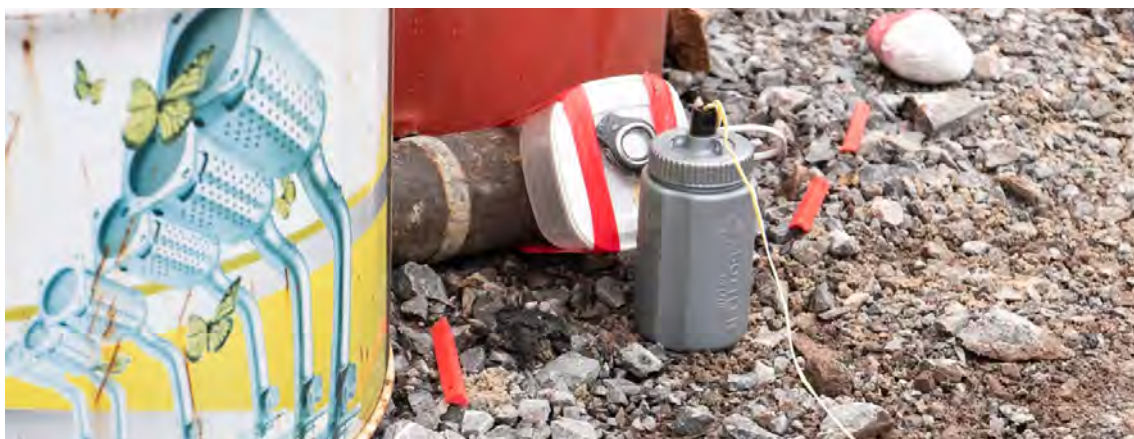
Image 8. Disrupteur à bouteille commercial placé pour cibler l'unité d'alimentation d'un retardateur
