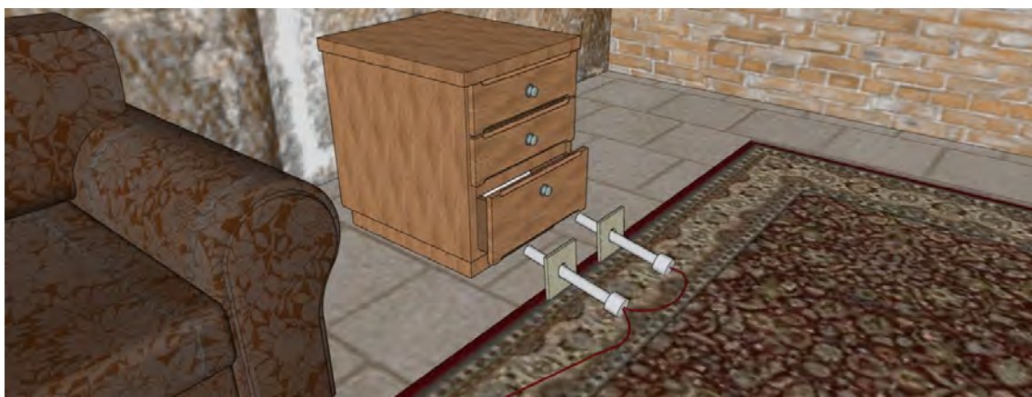
Image 1. Image d'un tir à double disrupteur. Notez le positionnement parallèle des canons, branchés en série
