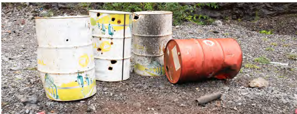
Image 9. Effet post-disruption. Notez comment le projectile et le baril d'huile ont également été déplacés sous l'effet de la force du disrupteur à bouteille
