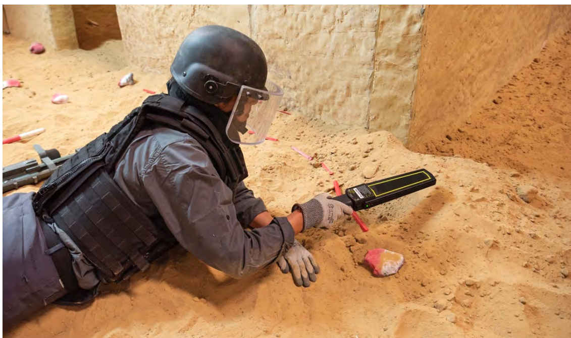
Image 10. Détecteur portable utilisé pour délimiter la signature métallique
