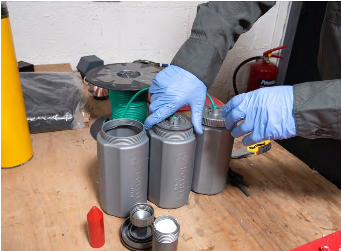
Image 3. Insertion du cylindre intérieur et fixation du bouchon sur un disrupteur à bouteille commercial. L'eau sera ajoutée avant utilisation
