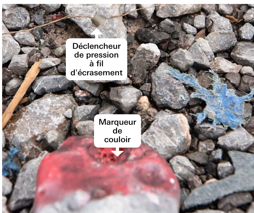
Image 13. Déclencheur à fil d'écrasement laissé en surface localisé au moyen d'une baguette de détection de fils-pièges
