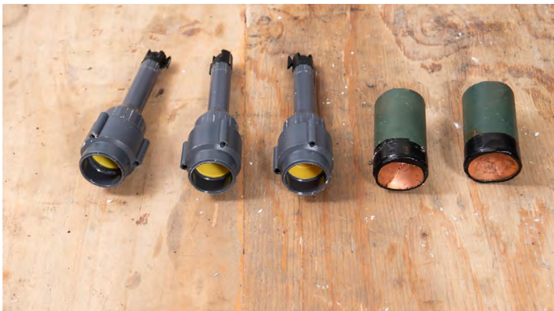
Image 11. Trois charges creuses commerciales remplies par l'utilisateur modulables de 30 mm placées à côté de deux charges creuses de fabrication artisanale de 40 mm
