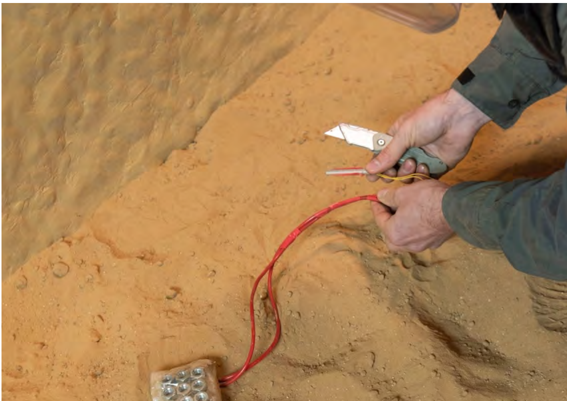
Image 6. Le détonateur est à présent retiré du cordeau détonant. Note : l'opérateur EEI manipule le détonateur par la base en toutes circonstances
