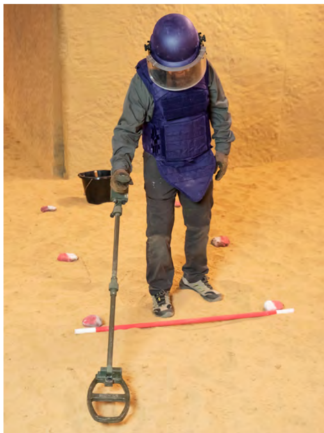
Image 6. Détecteur effectuant le balayage final avant de déplacer le marqueur de progression
