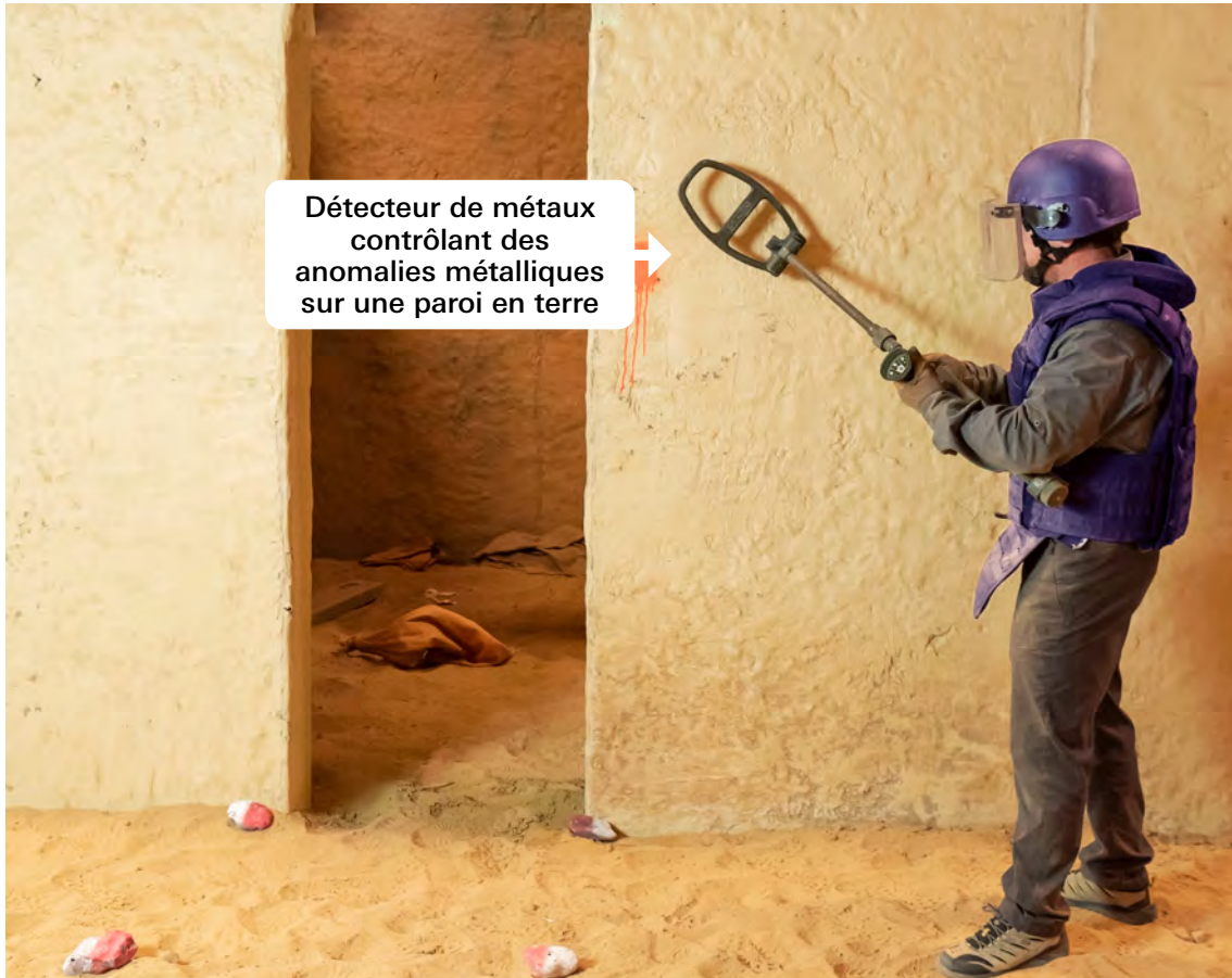
Image 7. Certains bâtiments sont dotés d'une ossature métallique de faible épaisseur, néanmoins les détecteurs de métaux peuvent tout de même s'avérer bénéfiques pour les opérations de fouille
