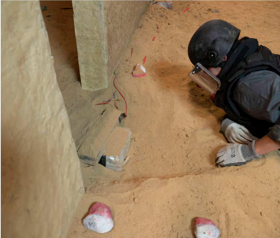
Image 12. Niveaux appropriés de fouille de l'opérateur face à une menace de composants reliés éventuels. Notez que l'opérateur EEI n'a pas travaillé au-dessus du déclencheur pour y parvenir
