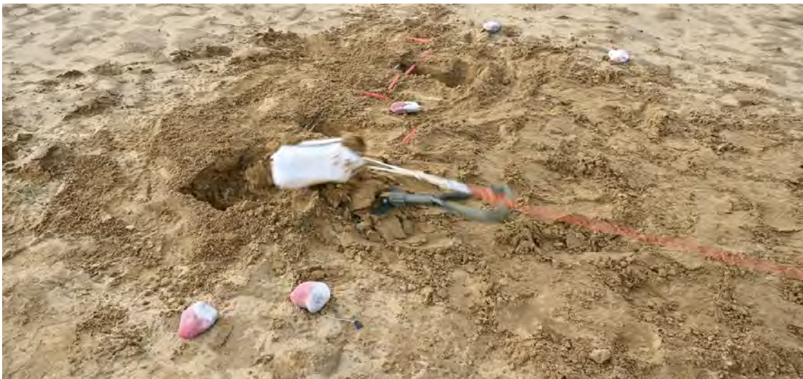
Image 10. L'utilisation d'une bêche pour créer un point de pivot surélevé facilite le retrait de la charge principale en la soulevant et en la tirant
