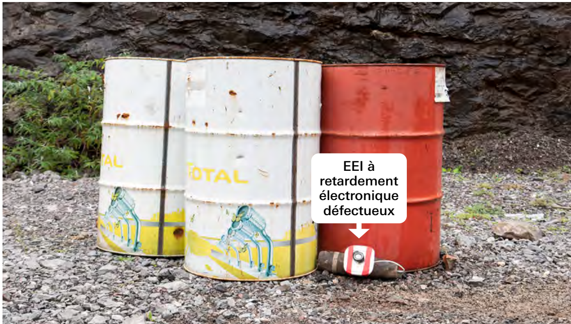
Image 25. EEI à retardement électronique défectueux, associé à un explosif conventionnel comme charge principale
