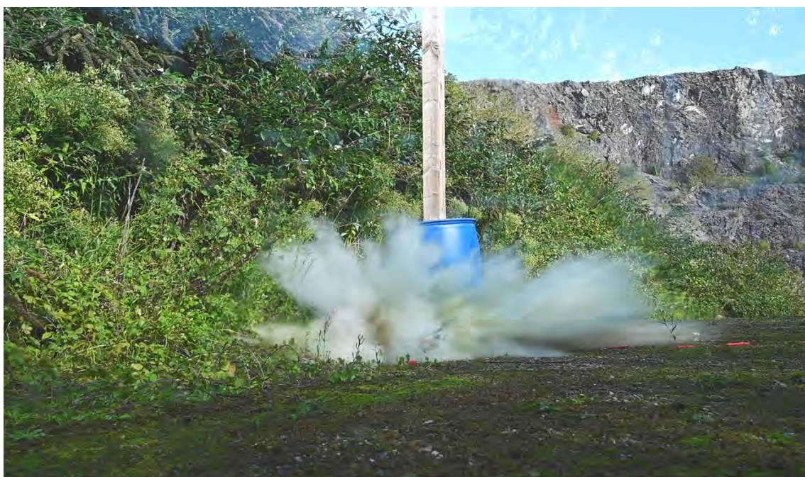
Image 21. Le disrupteur à bouteille improvisé de 500 ml se déclenche et l'eau supprime l'effet de chaleur et le flash
