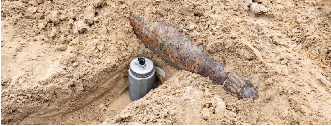
Image 4. Disrupteur à bouteille commercial placé dans une tranchée excavée pour cibler la source d'alimentation du déclencheur anti-soulèvement
