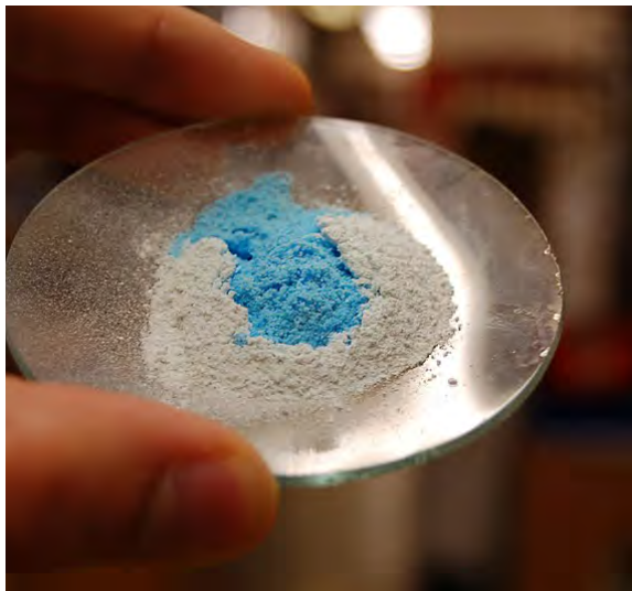
Image 93. Sulfate de cuivre. La poudre de sulfate de cuivre blanche et sèche devient bleue au contact de l'eau
