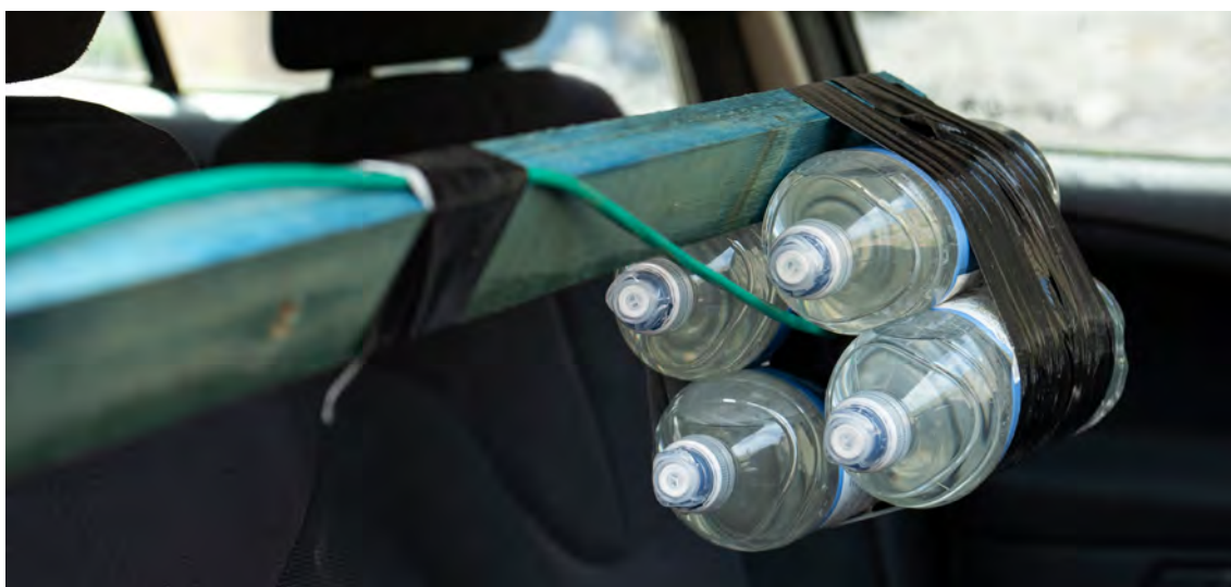
Image 2. Les opérateurs EEI ont souvent besoin de concevoir localement des outils reposant sur une solide compréhension des principes d'utilisation des explosifs. Ici, un disrupteur improvisé a été conçu pour procéder à la disruption générale d'un EEI placé dans un véhicule
