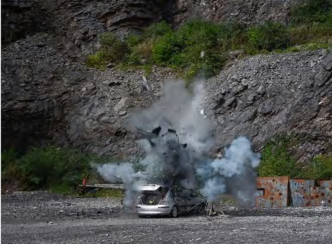
Image 1. Disrupteur d'EEI improvisé placé dans un véhicule qui s'est déclenché sur une zone d'essai
