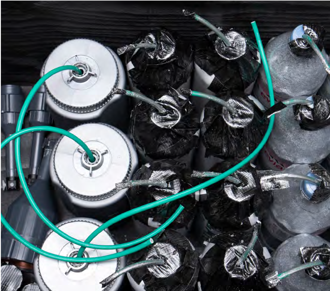
Image 7. Charges creuses et disrupteurs à bouteille commerciaux préparés avec des explosifs artisanaux cibles pour effectuer des démonstrations afin d'étayer ce guide
