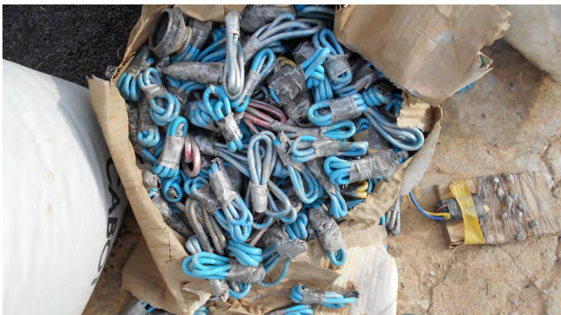
Image 17. Boosters pour charges principales d'explosifs artisanaux fabriqués à partir d'un cordeau détonant improvisé (source: FSD ©)
