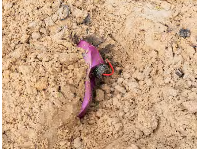
Image 7. La source d'alimentation enfouie est retirée du circuit d'un EEI à fil d'écrasement avec interaction minimale d'un opérateur EEI
