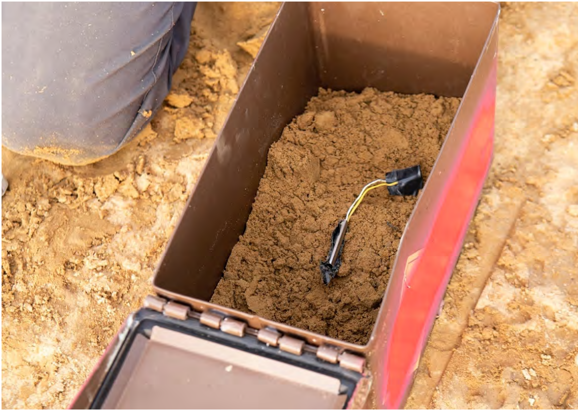
Image 7. Détonateur placé dans une boîte métallique rigide pour le protéger des ondes RF et de tout dommage
