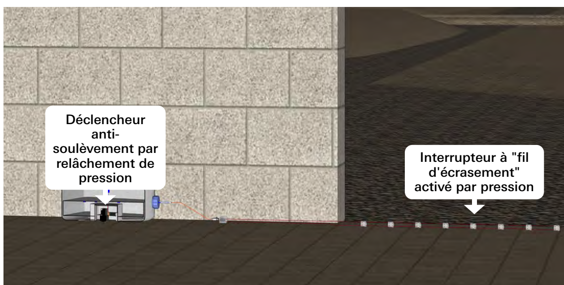
Image 68. EEI activé par la victime à déclencheurs multiples muni d'un fil d'écrasement activé par pression et d'un déclencheur anti-soulèvement par relâchement de pression
