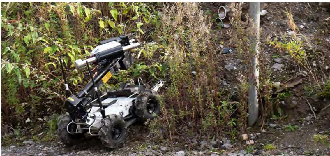
Image 2. ROV procédant à une REE d'une batterie de PFE placée au bord de la route
