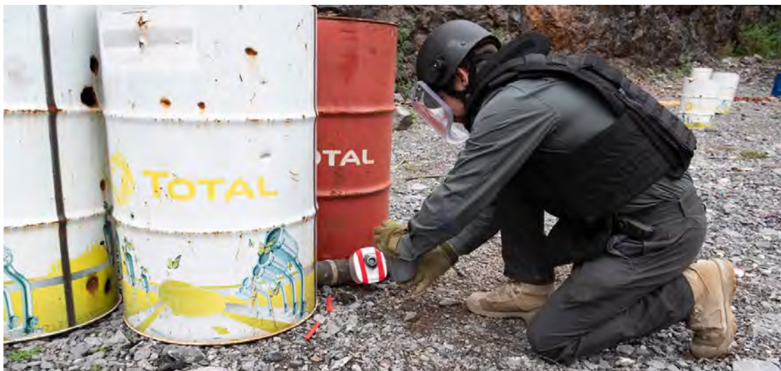
Image 7. Opérateur EEl mettant en place un disrupteur à bouteille commercial
