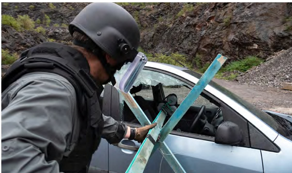
Image 8. Support improvisé utilisé pour placer un disrupteur d'EEI placé dans un véhicule au centre de l'habitacle
