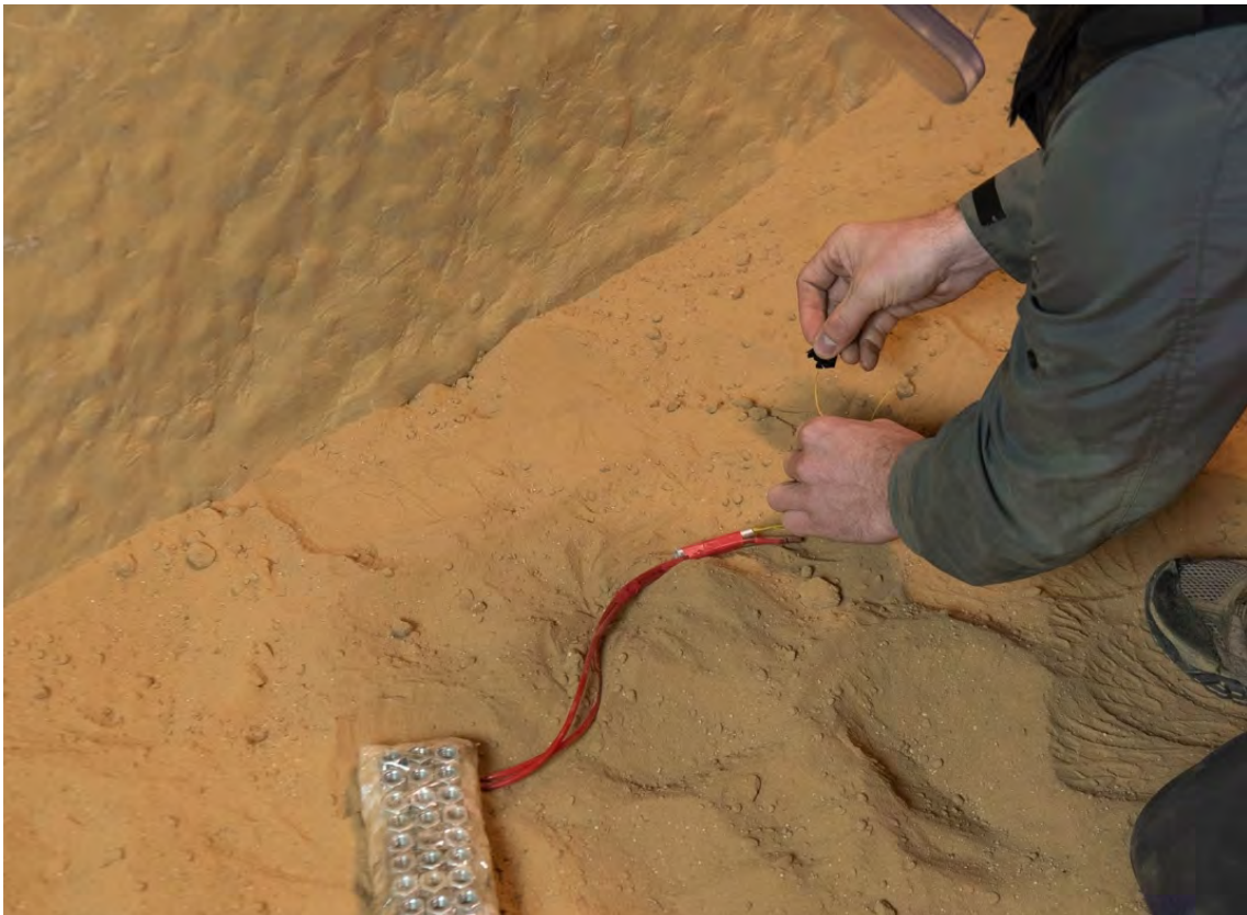
Image 2. Ruban adhésif utilisé pour isoler les fils des parasites
