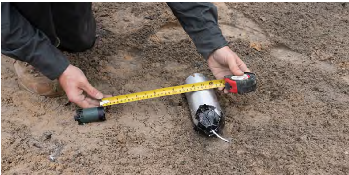
Image 13. Charge creuse produite localement placée à 90 degrés par rapport à l'axe médian de la cible avec une distance de sécurité suffisante pour que la charge creuse se forme
