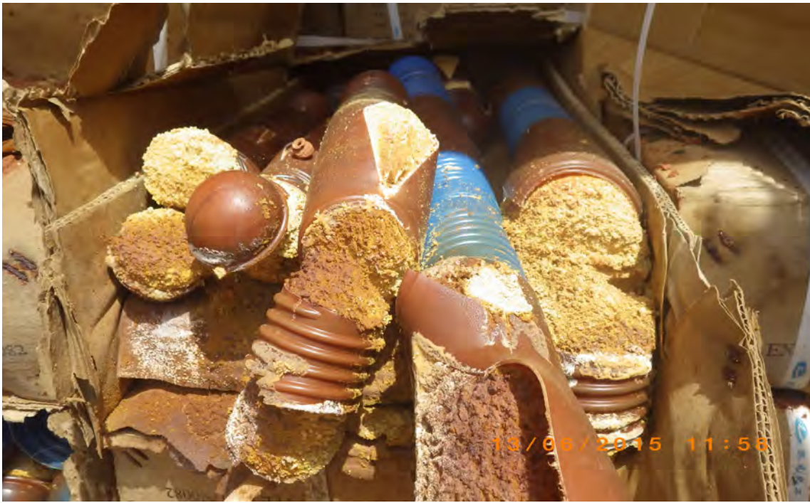
Image 118. Vieillesse: Explosif inconnu employé dans l'industrie minière vieilli après avoir été entreposé dans un conteneur non climatisé sous les tropiques pendant une période indéterminée. L'enveloppe est détruite et la décoloration de l'explosif est reconnaissable. Il est impossible d'évaluer les effets chimiques du vieillissement sur l'explosif (source : Stanislav Damjanovic ©)
