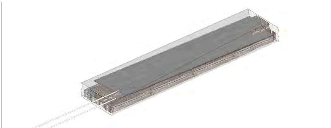
Image 45. Aperçu des deux lames de scie en métal utilisées comme contacts électriques
