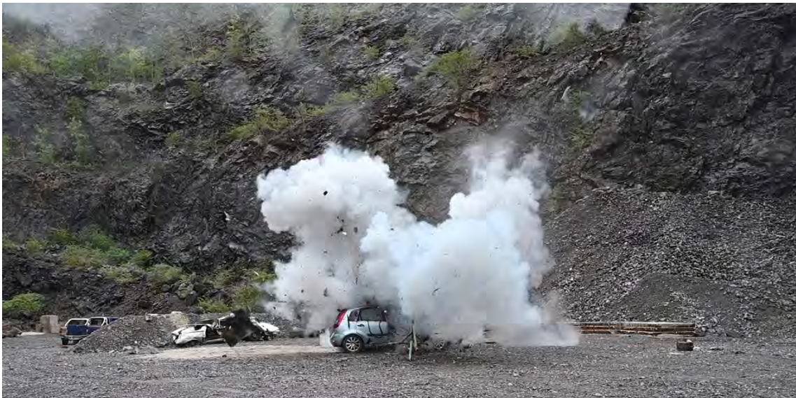
Image 13. Flash complètement supprimé et aucun début d'incendie du véhicule
