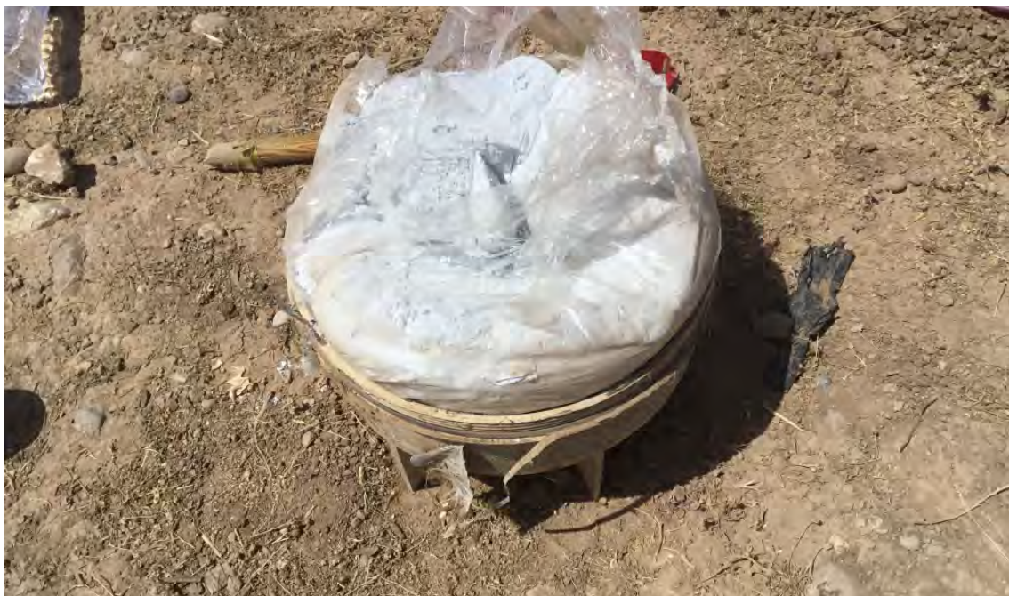
Image 22. Apparence d'un explosif artisanal inconnu utilisé dans une charge principale (source: FSD ©)
