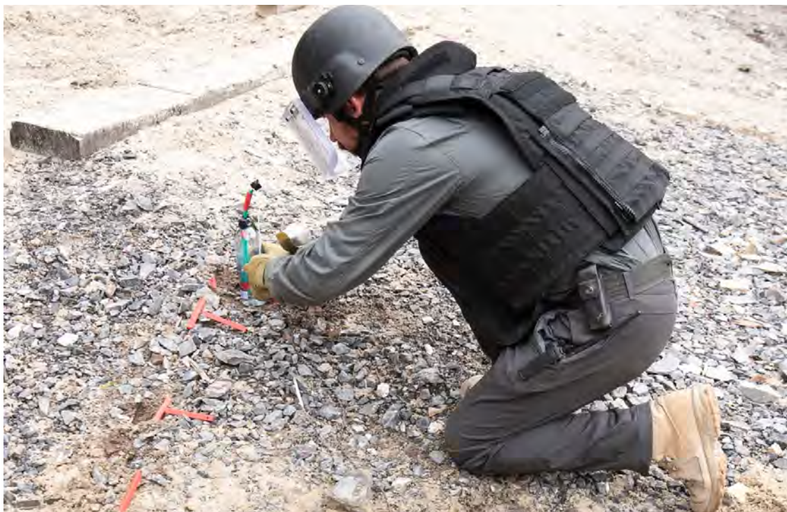
Image 14. Opérateur EEI plaçant un disrupteur à bouteille improvisé pour attaquer la source d'alimentation enfouie
