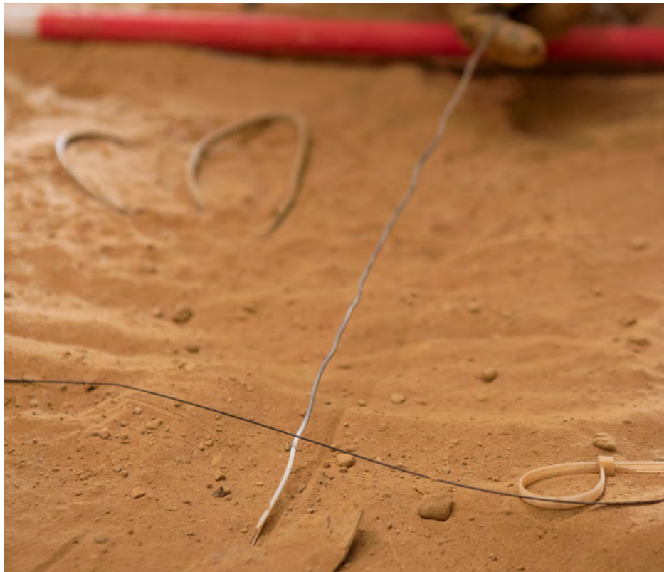
Image 10. Baguette de détection de fils-pièges poussée à travers les couches supérieures de sable pour localiser un fil-piège détendu. Notez que sur cette image, la baguette de détection ne touche pas le fil
