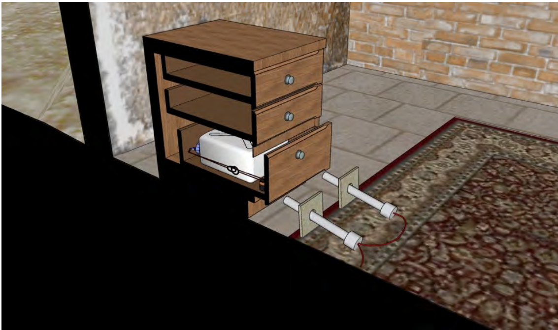
Image 2. Image montrant un EEI déclenché par la victime à l'intérieur d'un tiroir. Bien que la batterie soit visible, l'opérateur EEI ne connaît pas son emplacement précis. Il s'agit toutefois de la technique la plus sûre pour procéder à la neutralisation
