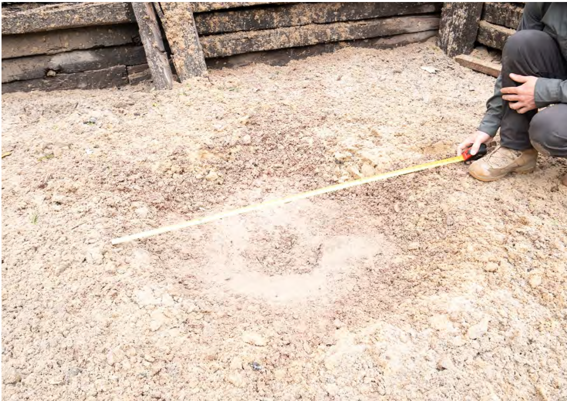
Image 2. Cratère provoqué par la détonation de haute intensité de la charge principale vue dans l'image 1
