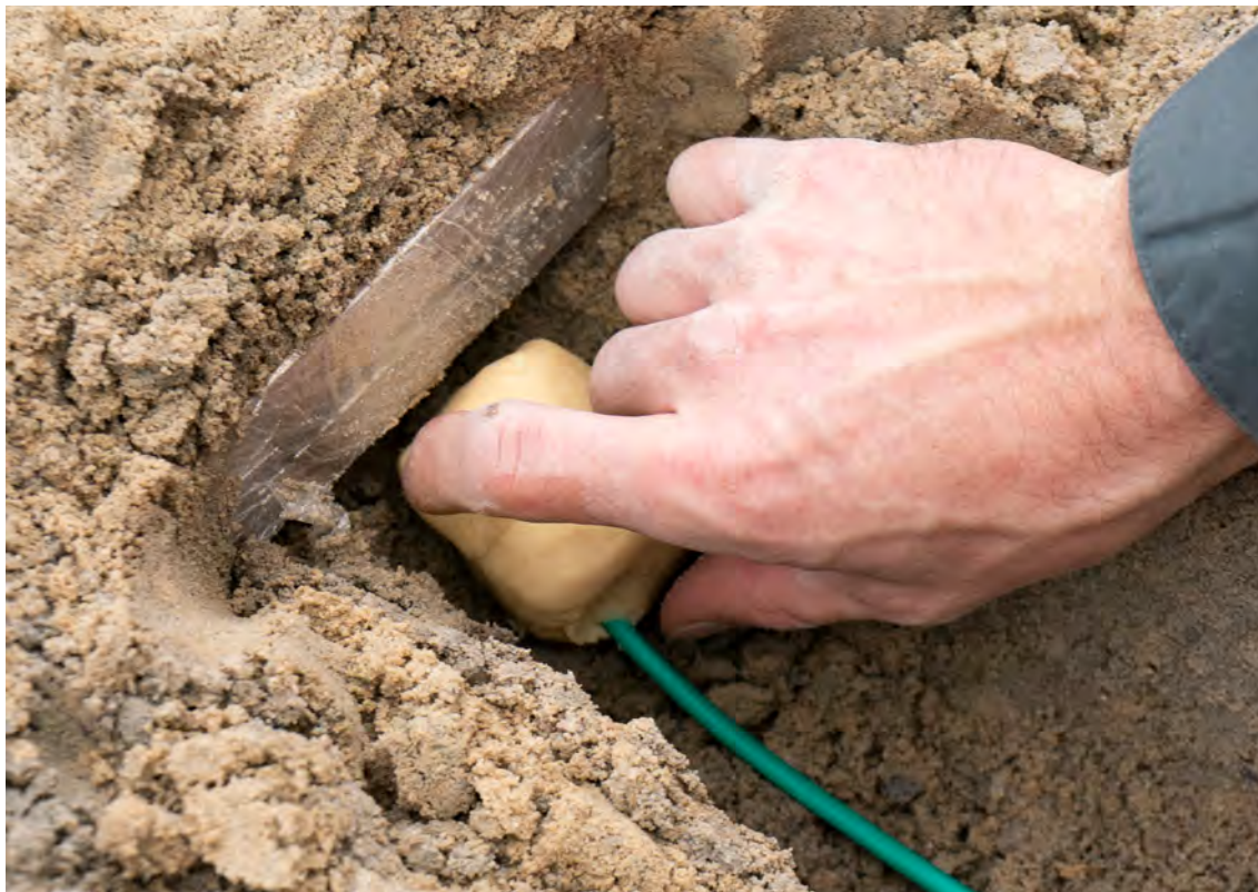
Image 3. Mise en place d'une charge suffisante d'explosifs utilisables pour détruire un EEl à plateau de pression
