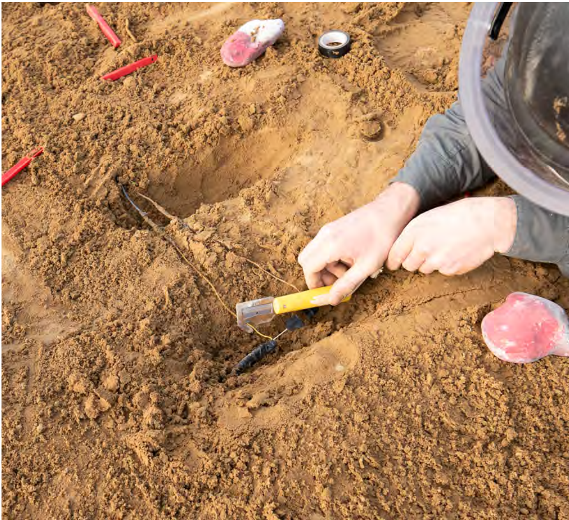
Image 9. Opérateur EEI procédant à une action concrète de façon semi-éloignée sur le second fil d'un détonateur après avoir déjà appliqué cette procédure au premier fil
