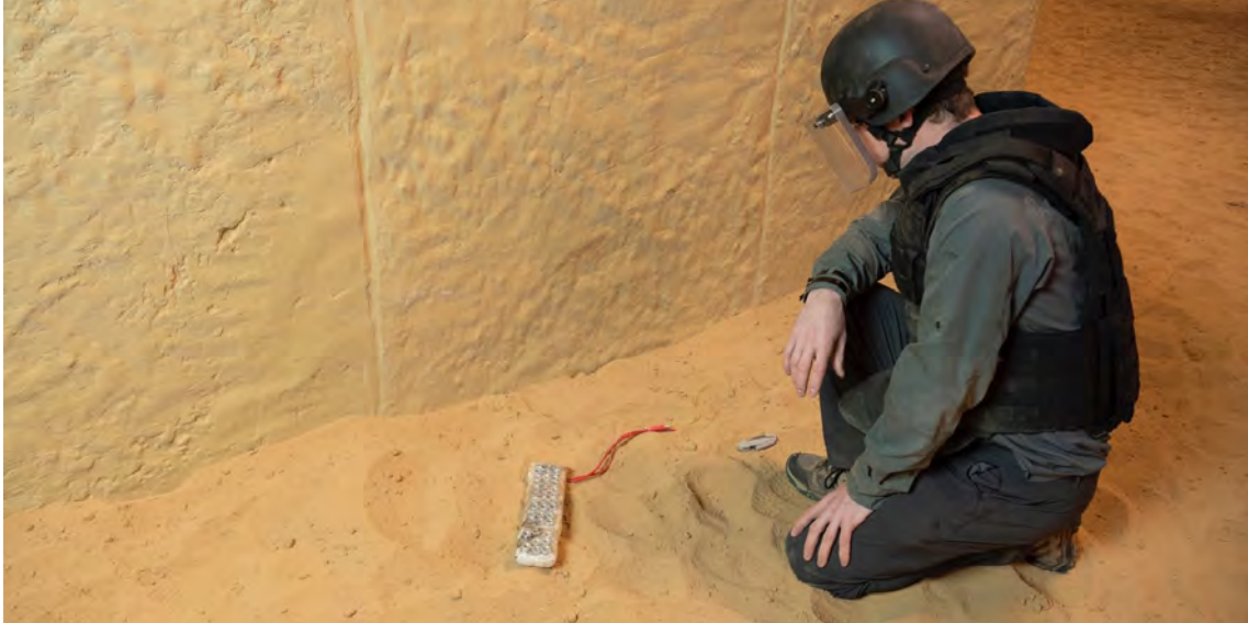
Image 1. Charge principale d'une ceinture d'explosifs munie d'un détonateur électrique fixé au cordeau détonant. Tous les autres composants de l'EEL ont déjà été enlevés dans le cadre de la procédure de mise hors d'état de fonctionner
