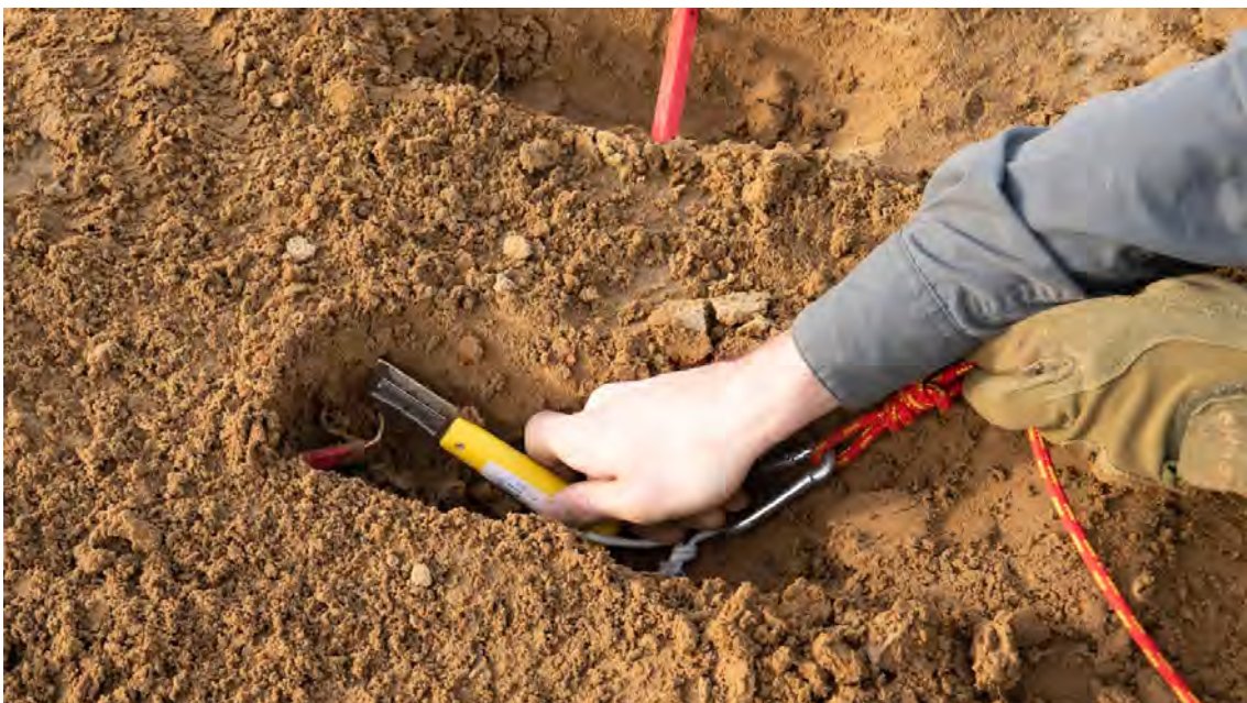
Image 3. Positionnement du cutter. Notez que l'opérateur EEI garde le contrôle tout au long du processus pour éviter d'altérer le fil de la cible
