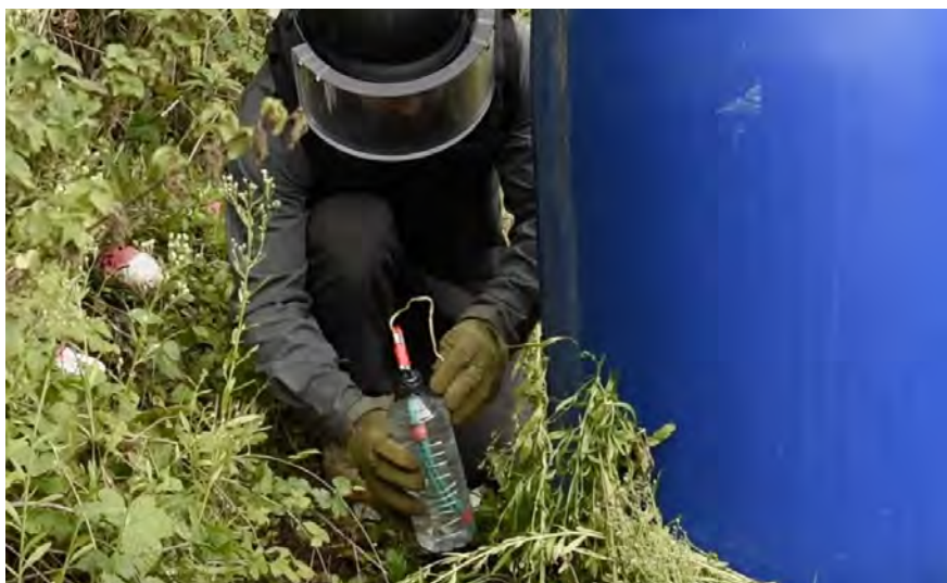
Image 4. Opérateur EEI mettant en place un disrupteur à bouteille
