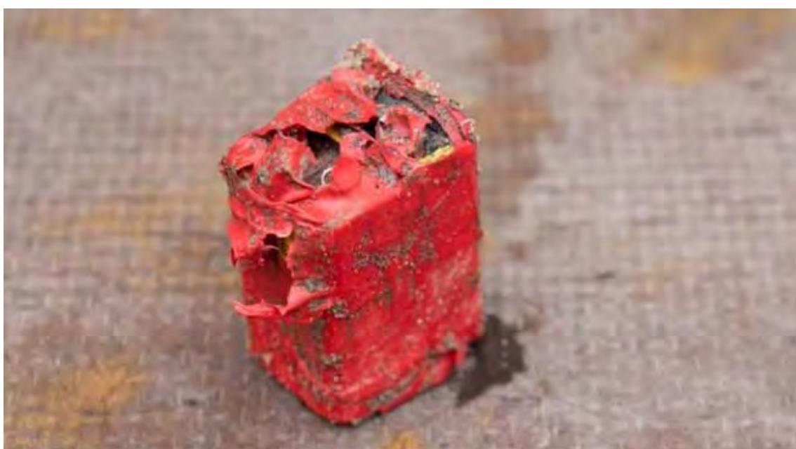
Image 15. Source d'alimentation post-disruption. Notez que la source d'alimentation est intacte et que seuls les fils ont été retirés
