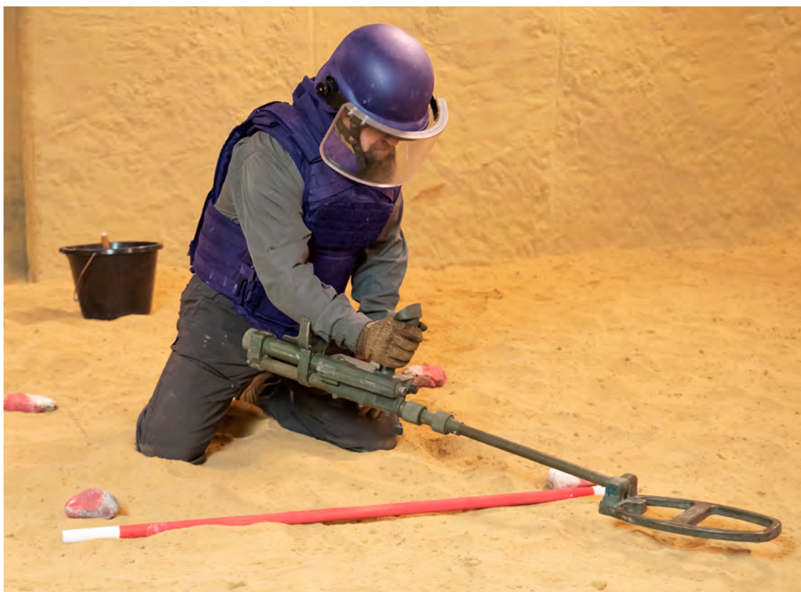
Image 3. Utilisation du détecteur à l'intérieur de la zone sécurisée en position agenouillée stable
