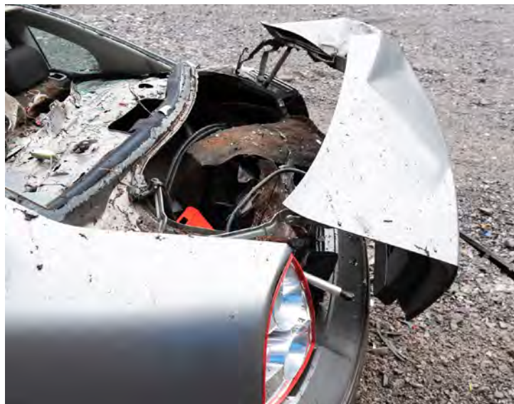
Image 35. Le coffre après le déclenchement de l'extracteur d'EEI placé dans un véhicule
