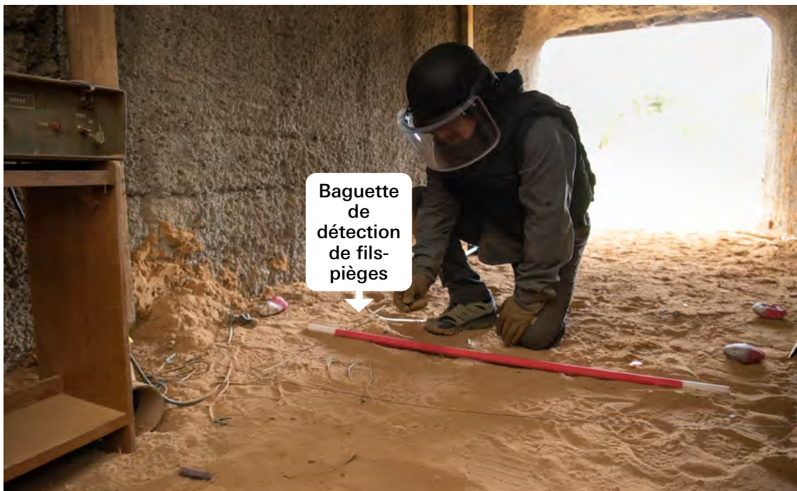
Image 9. Utilisation d'une baguette de détection de fils-pièges dans une voie de passage où la lumière naturelle se fait plus rare
