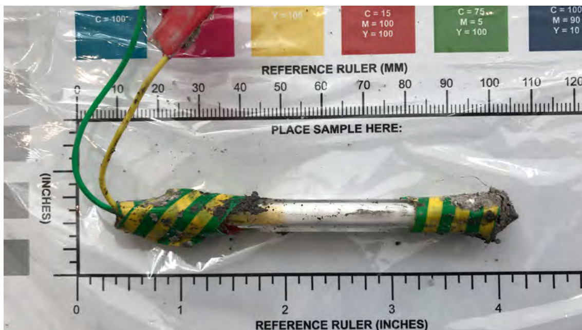
Image 189. Détonateur à amorçage électrique utilisant des explosifs improvisés à base de chlorate et de peroxyde organique (source: BCL ©)
