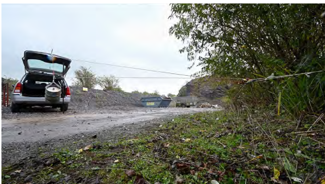
Image 13. L'opérateur utilise la corde rouge pour soulever la charge principale, puis la corde blanche pour la tirer hors du véhicule
