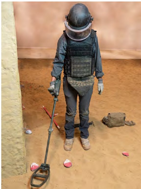
Image 15. Détecteur de métaux principal utilisé pour rechercher d'autres emplacements probables de charges principales
