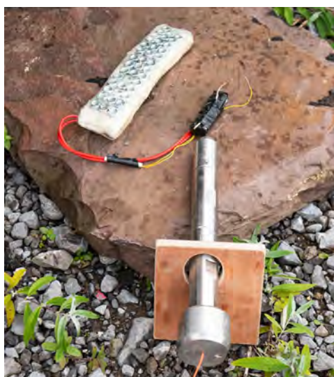
Image 5. Disrupteur à canon ciblant la source d'alimentation sur une ceinture d'explosifs abandonnée. Un support de fabrication artisanale est utilisé pour faciliter la mise en place
