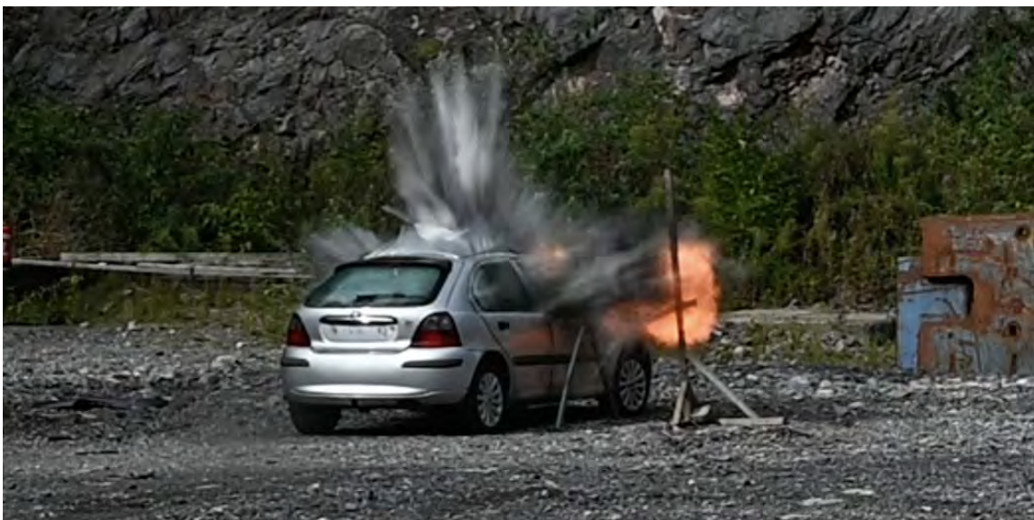
Image 21. Déclenchement du disrupteur improvisé d'EEL placé dans un véhicule. Notez le flash du cordeau détonant mais l'eau a largement supprimé l'explosif en vrac dans le disrupteur (version HD de la vidéo requise)
