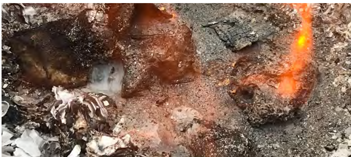
Image 179. Restes d'un incendiaire improvisé (à base de gel), qui s'est rallumé au contact de l'oxygène atmosphérique dans les cendres d'un local commercial (source : BCL ©)
