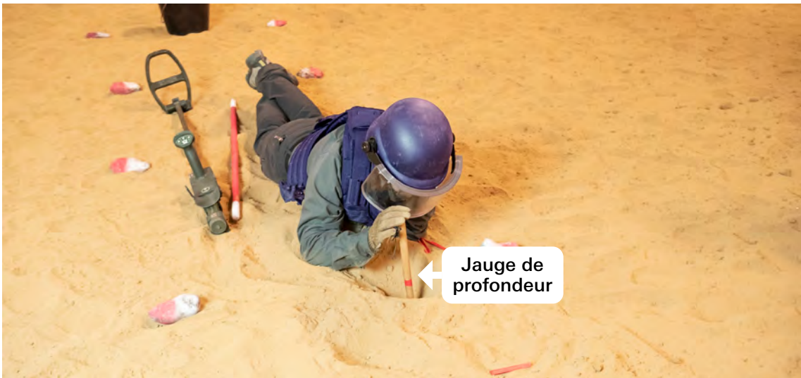
Image 9. La profondeur correcte de l'excavation peut être vérifiée au moyen d'une jauge de profondeur dédiée
