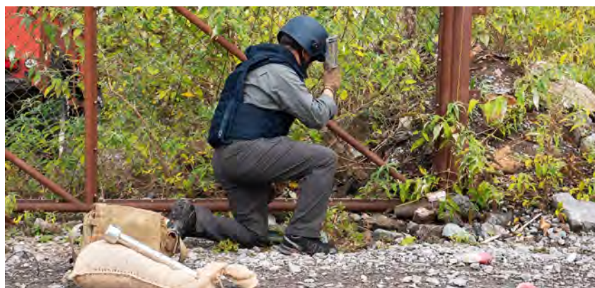
Image 3. L'opérateur EEI s'est approché de l'EEI et a placé le disrupteur à canon en l'orientant dans une direction qui ne présente aucun danger jusqu'à ce qu'il soit en mesure de le positionner
