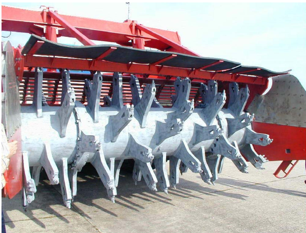
Abb. 2: Fräse bestehend aus der Fräswalze mit den Fräsmeißeln
