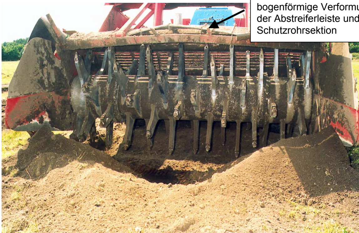
Abb. 7 u. 8: Räumereinrichtung nach dem Auslösen der 3. PzAbwMi – DM 21
