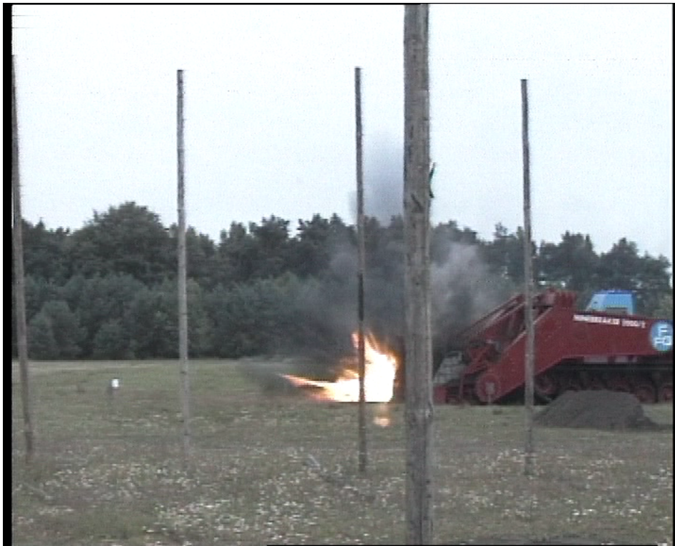
Abb. 12 u. 13: Räumvorgang PzAbwMi-TM62 P3 mit Auslösung der Mine
