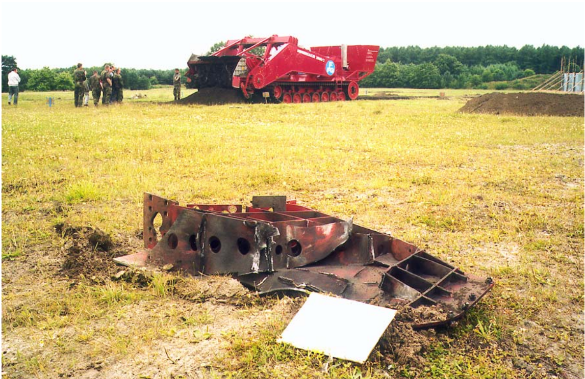
Abb. 16 u.17: Deformiertes und abgerissenes Abweiserblech links. Position nach dem Auslösen der PzAbwMi TM 62 P3
