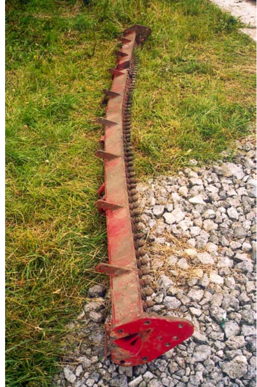
Abb. 9 u. 10: Verformte Abstreiferleiste und beschädigte Schutzrohrsektion
