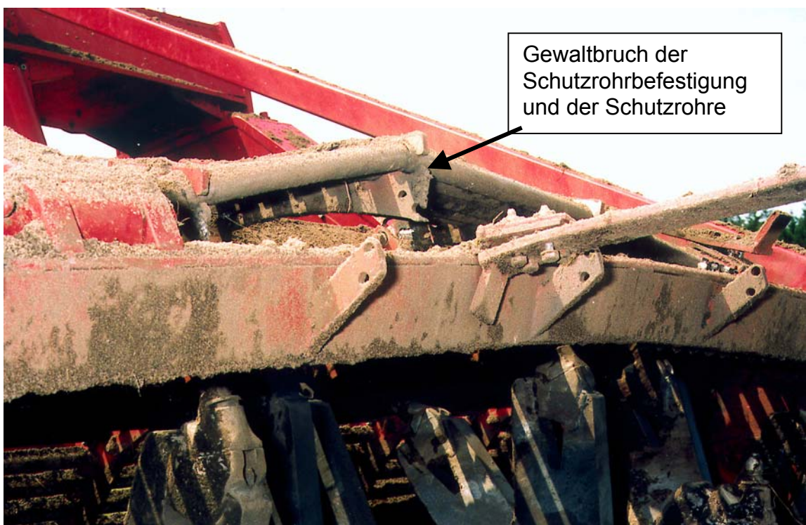
Abb. 7 u. 8: Räumereinrichtung nach dem Auslösen der 3. PzAbwMi – DM 21
