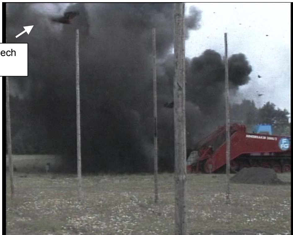
Abb. 12 u. 13: Räumvorgang PzAbwMi-TM62 P3 mit Auslösung der Mine
