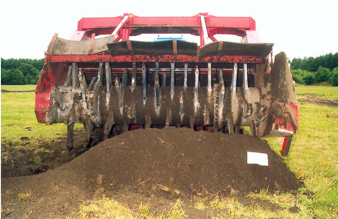
Abb. 14 u. 15: Räumeinrichtung nach dem Räumvorgang mit der PzAbwMi – TM62 P3 Das linke Abweiserblech fehlt.
