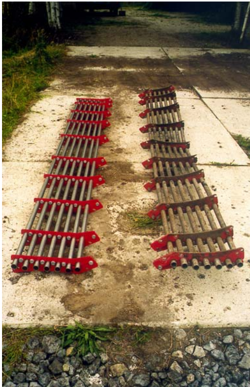
Abb. 9 u. 10: Verformte Abstreiferleiste und beschädigte Schutzrohrsektion
