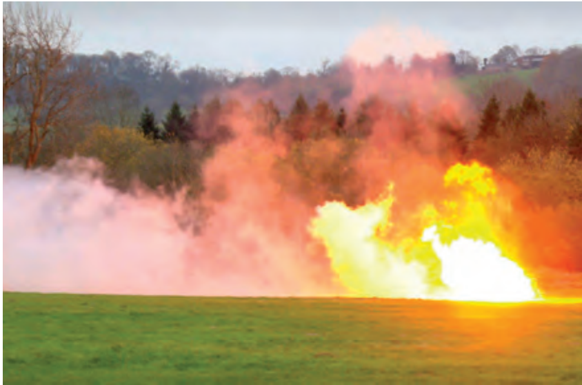
Figura 1 – Destrucción del excedente de propelentes por quema (Fuente: Ammunition Technical Trade UK)
