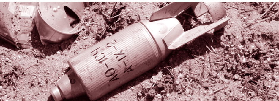
Illustration 3 | Sous-munition russe AO-1Sch | © Colin King
