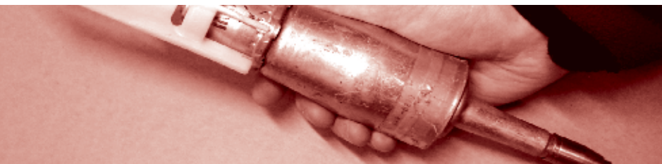
Рисунок 4 | Противоброневый субснаряд «Roskeye» | ©Колин Кинг
