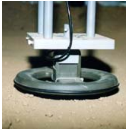
Figure 5.1: Förster Minex 2FD detector head on gantry support frame [BRU00b].
